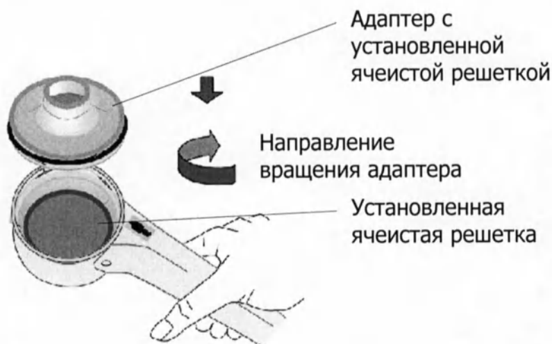
Рис. 7: исполнение custo vit m/R, пневмотахограф, установка измерительной решетки
