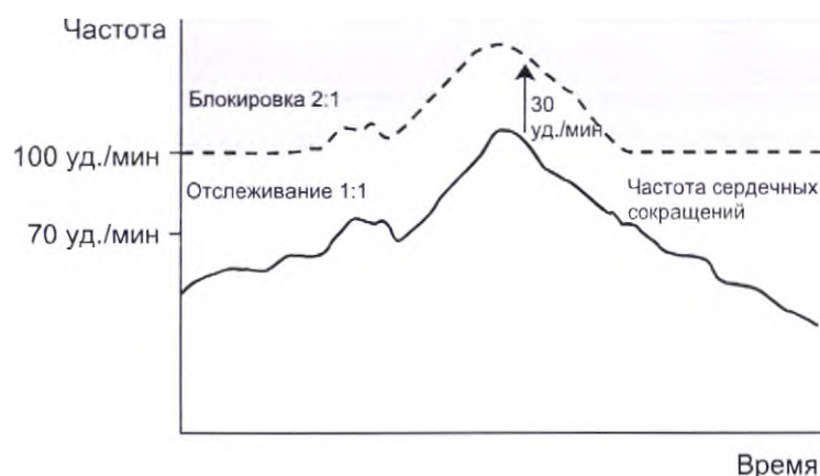
Рисунок 88. Действие параметра Auto PVARP (Автоматический ПЖПРП) в режиме DDDR или DDD
