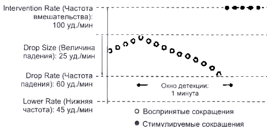
Рисунок 92. Метод Drop Detection (Детекция падения частоты)
