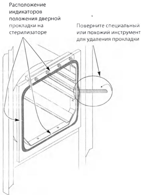
Рисунок 10-2. Удаление прокладки двери
