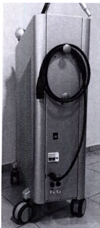
Рисунок 40: Расположение кабеля питания при хранении/транспортировке
