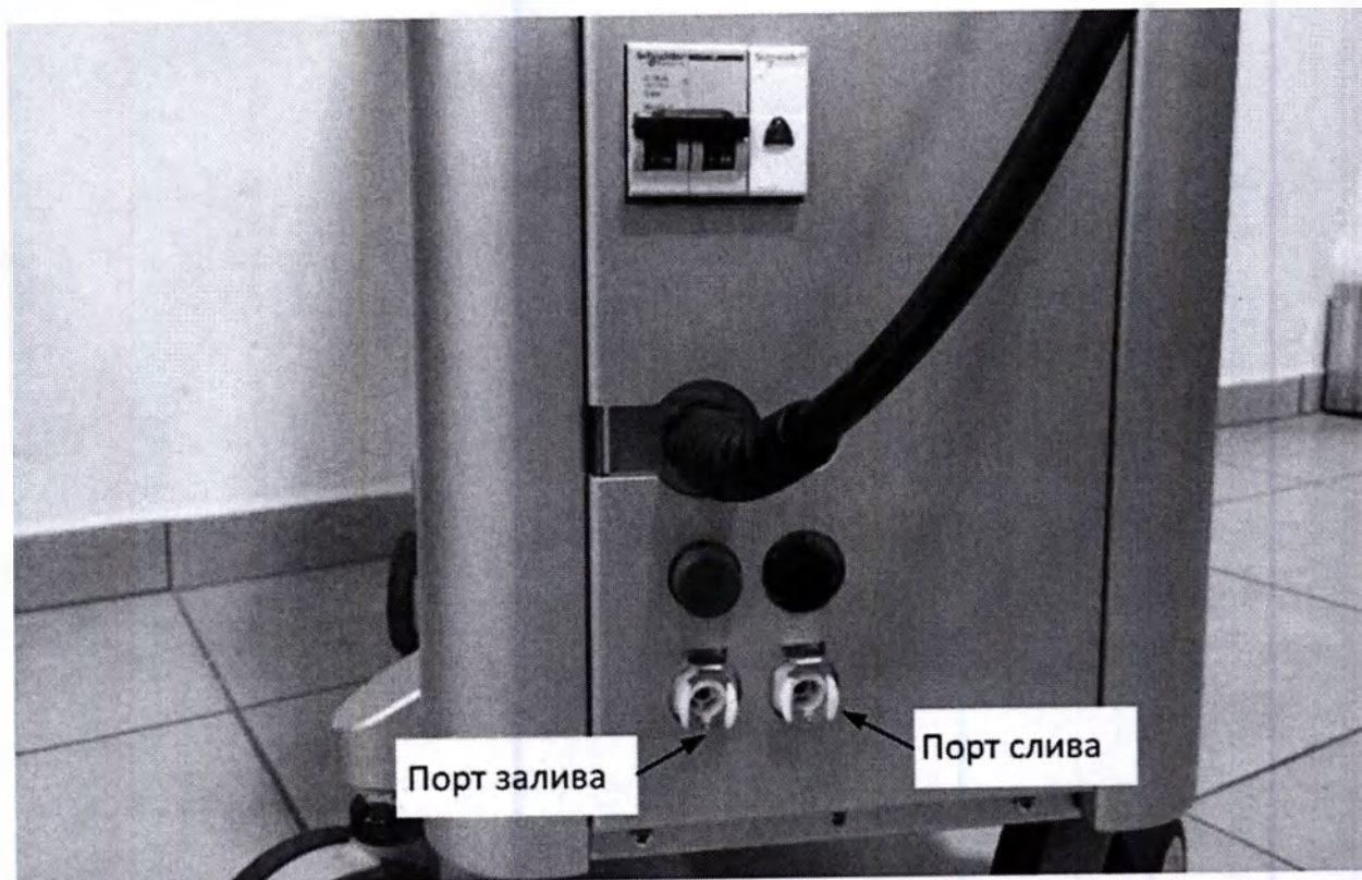
Рисунок 43: Порты для залива (FILL) и слива (VENT) охлаждающей жидкости
