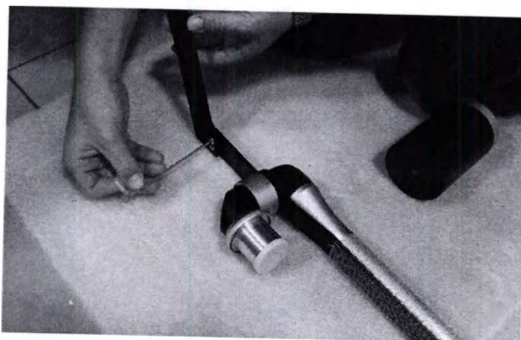
Рисунок 33: Соединение ручки держателя противовеса
