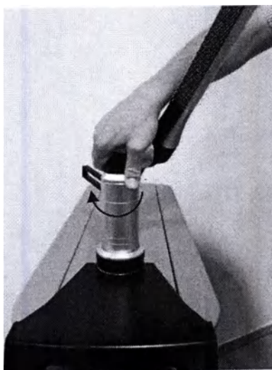
Рисунок 36: Закрепление шарнирной консоли
