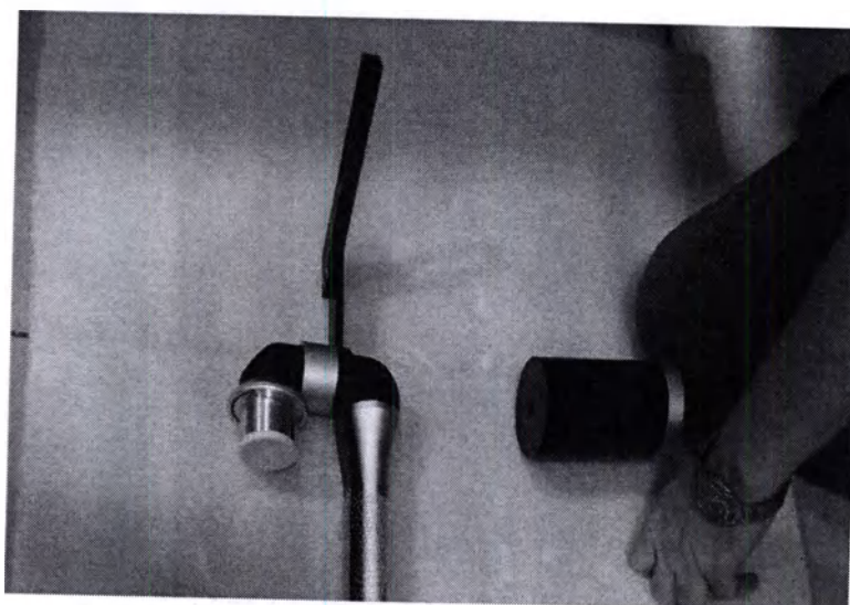
Рисунок 34: Шарнирный кронштейн с присоединенной ручкой-держателем противовеса
