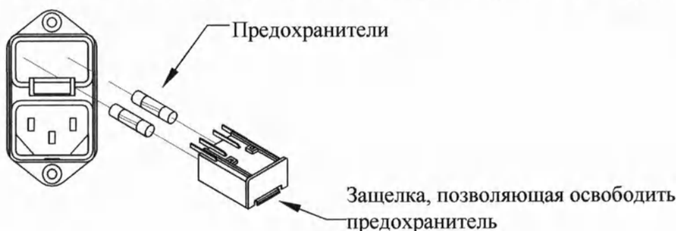
Рисунок 24. Замена плавкого предохранителя видеопроцессора EndoSite Digital
