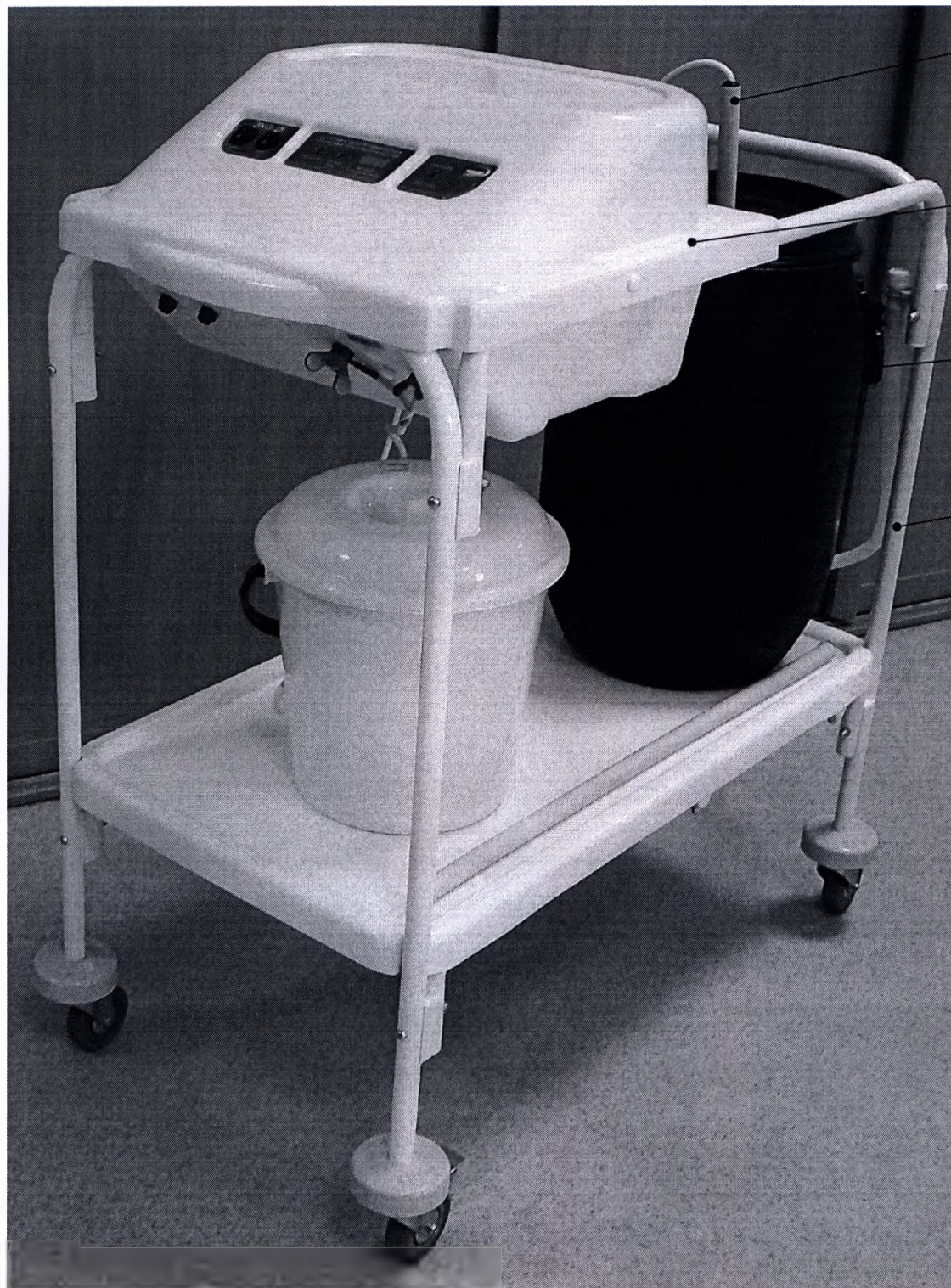
Фото 1. УСТАНОВКА ЭЛЕКТРОХИМИЧЕСКАЯ ПОЛУЧЕНИЯ ДЕЗИНФИЦИРУЮЩЕГО РАСТВОРА ГИПОХЛОРИТА НАТРИЯ ДЛЯ ТЕКУЩЕЙ ДЕЗИНФЕКЦИИ ПОМЕЩЕНИЙ, ОБОРУДОВАНИЯ И ДРУГИХ ИЗДЕЛИЙ ЭКО-«КРОНТ»,
