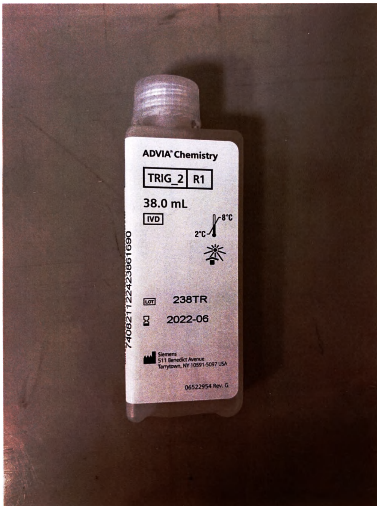
Рисунок 2. Реагент для определения триглицеридов_2 (ADVIA Chemistry Triglycerides_2 Reagent (TRIG_2)): Реагент 1 (TRIG_2|R1), контейнер емкостью 40 мл (38 мл реагента/контейнер)
