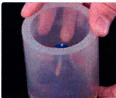
Осторожно установите кольцо силиконовое IPS Silicone Ring 200 г на кольцо-основании IPS Multi Investment Ring Base 200 г. Убедитесь в том, что кольцо расположено вровень с кольцом-основанием
