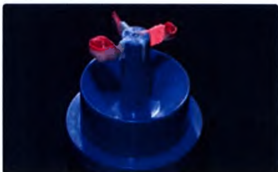
Подготовленное кольцо-основание IPS Multi Investment Ring Base с закрепленной воском восковой моделью
