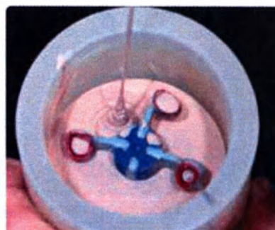
Медленно заполняйте кольцо-основание массой паковочной таким образом, чтобы масса равномерно заполняла кольцо.
