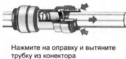
Рис. 5-4. Отсоединение гибкой трубки
