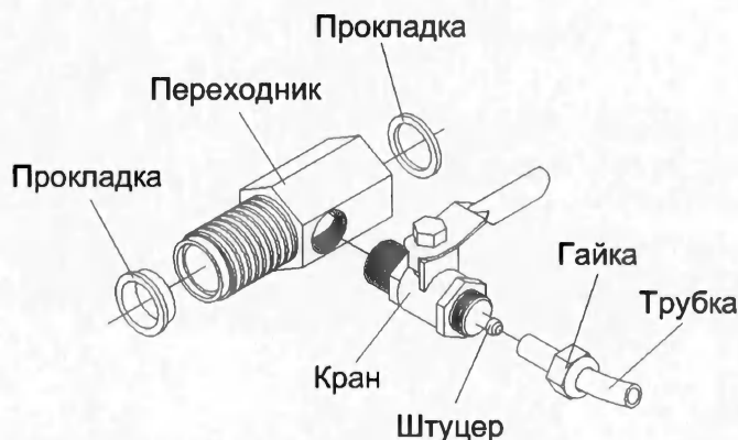
Рис. 5-1. Подключение к водопроводу с помощью комплекта SV-1
