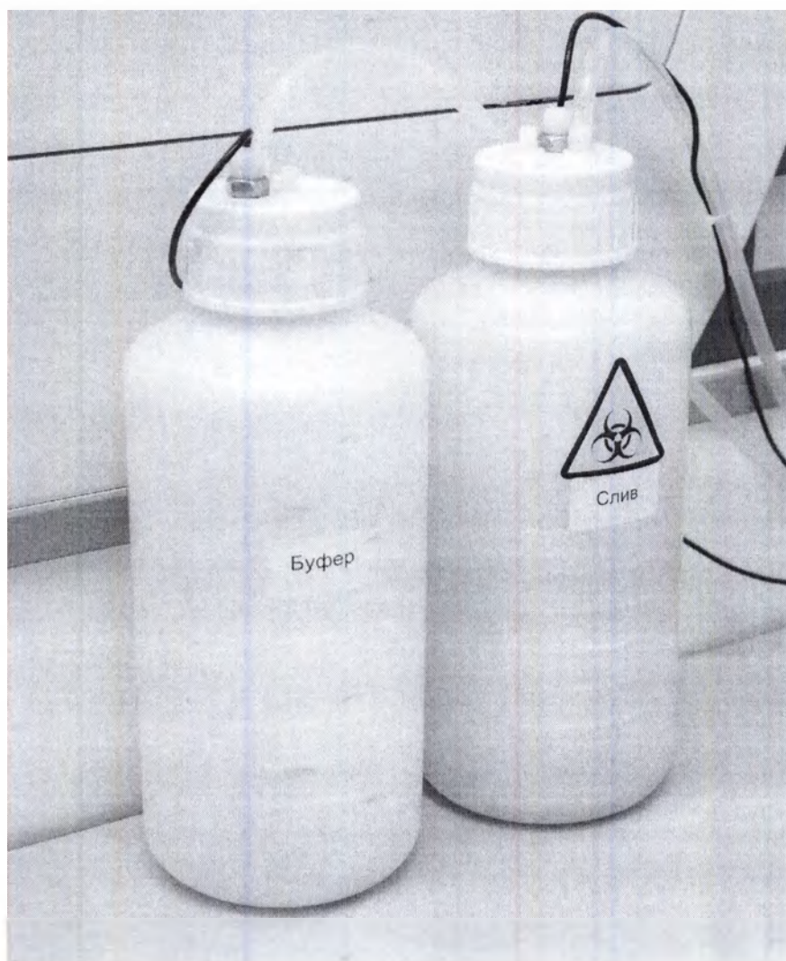
Рисунок 4 – Емкость для промывочного и консервирующего растворов с датчиком и соединительными штуцерами и Емкость для жидких отходов с датчиком и соединительными штуцерами (слева на право)
