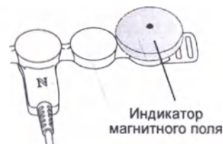
Рис. 6. Проверка наличия магнитного поля с помощью индикатора
