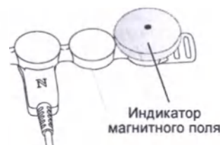
Рис. 6. Проверка наличия магнитного поля с помощью индикатора
