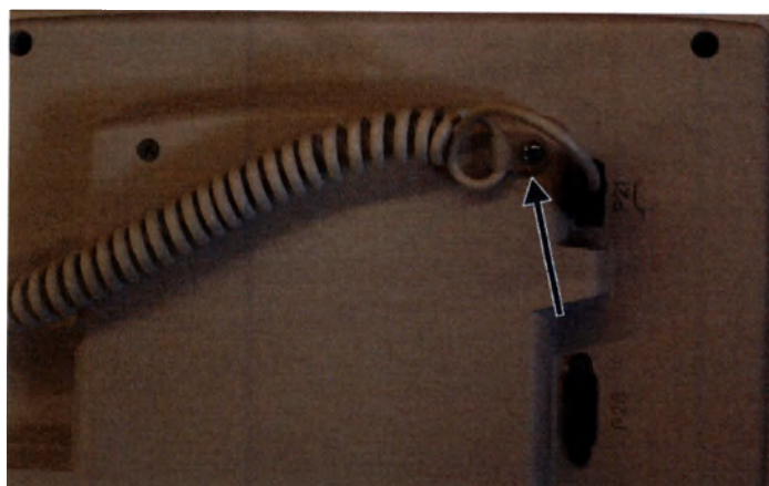
Рисунок 16 — 33. Для подключения кабеля переключателя ручного к панели блока управления дисплеем используйте зажим.
