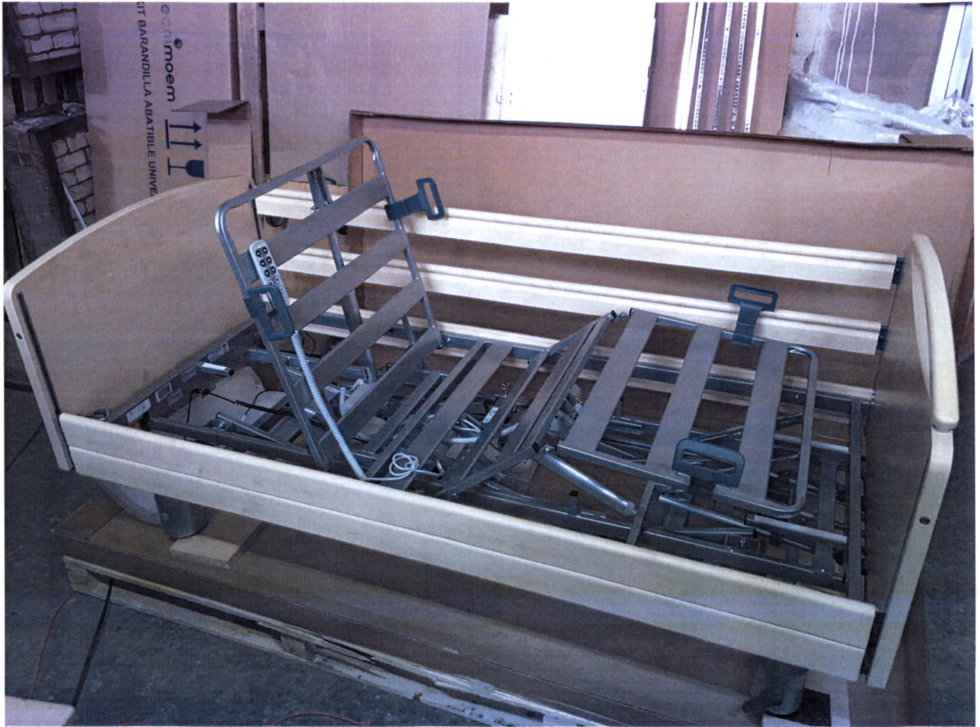
13. 4-х секционное металлическое матрацное основание (Metal mattress base in four section)
