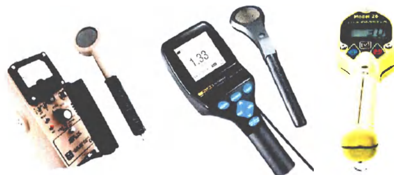
Примеры внешнего вида счетчиков Гейгера-Мюллера (измерительные приборы для определения уровня ионизирующего излучения)
