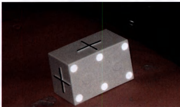
Рис. 47 Блок отражателя, применяемый для синхронизации
