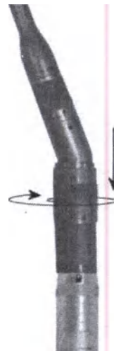
Εικόνα 32: Εισαγωγή του εργαλείου διατομής μέσα στο προσάρτημα
