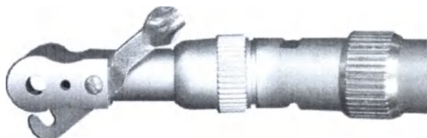
Εικόνα 44: Άνοιγμα του μοχλού της κεφαλής του προσαρτήματος
