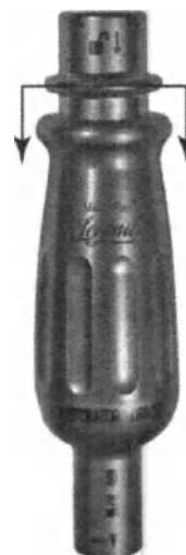
Εικόνα 54: Τραβήγμα του κολάρου προς τα πίσω
