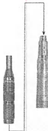
Рисунок 45: Закрепление насадки в зажиме мотора
