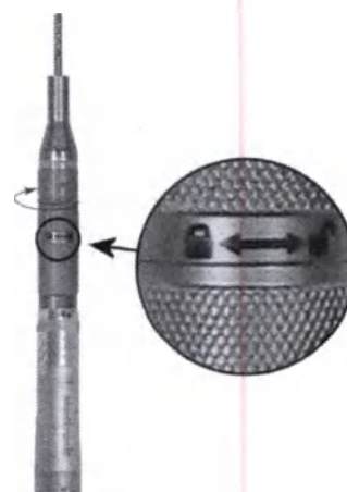
Figura 47: Giro del sistema de fijación hasta la posición de cierre
