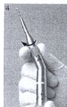
Механизм фиксации инструмента «разблокирован»
