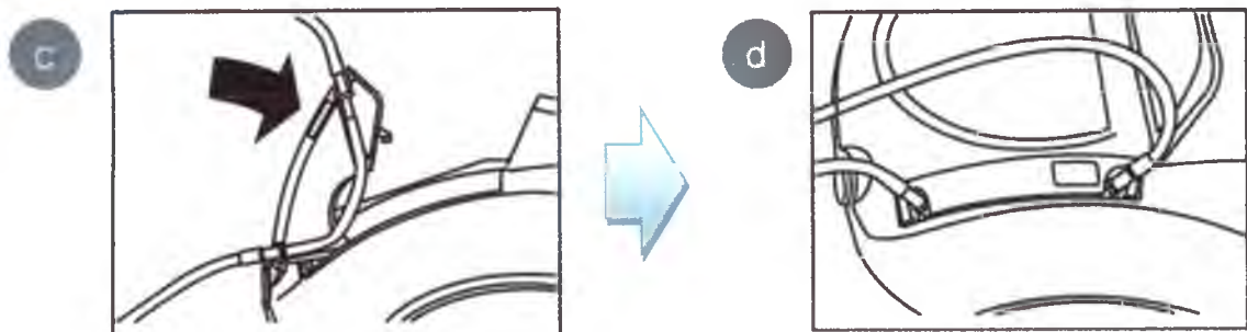
Установка трубки ирригационной в насос
