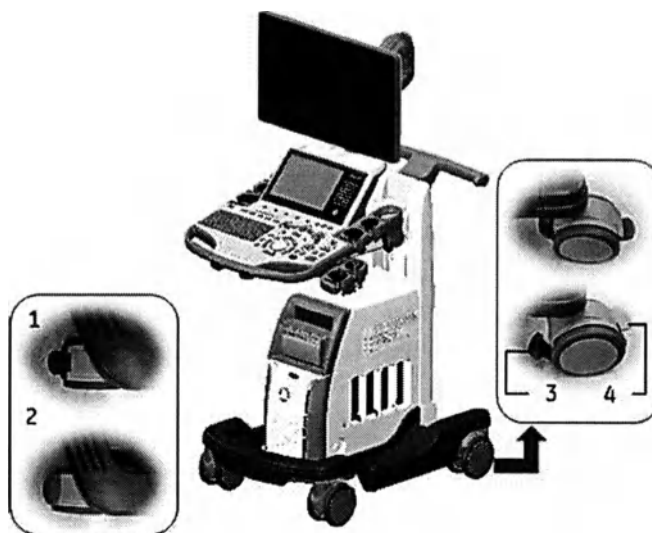
Рис. 1-16. Блокировка колеса и блокировка поворота
