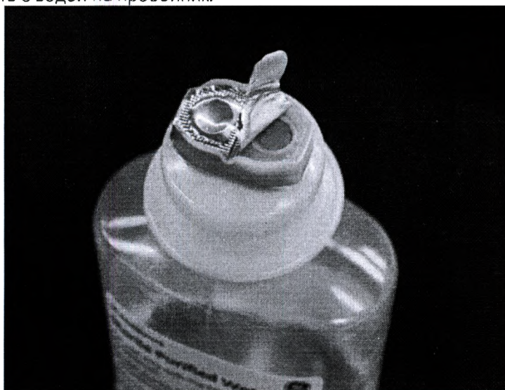
РИСУНОК 5-25. Перед установкой емкости с водой снимите с нее защитную алюминиевую фольгу
