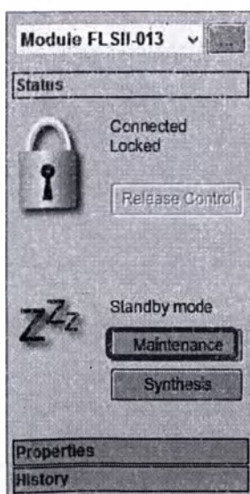
РИСУНОК 0-6: Нажать кнопку «Обслуживание» (Maintenance), чтобы запустить новый процесс синтеза.
