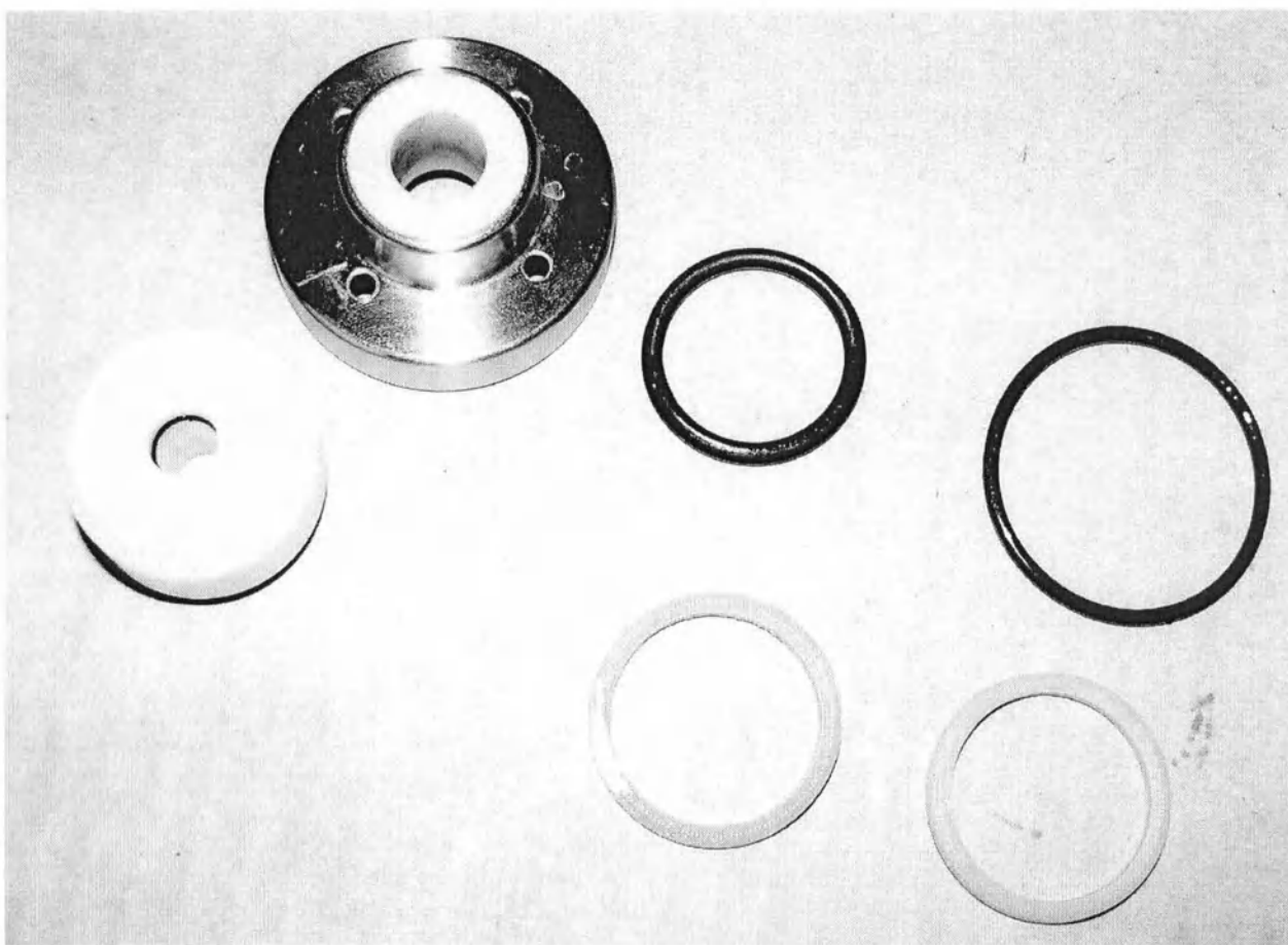
(рис. фото деталей дозирующего насоса, рекомендуемые к обработке химическим методом)
