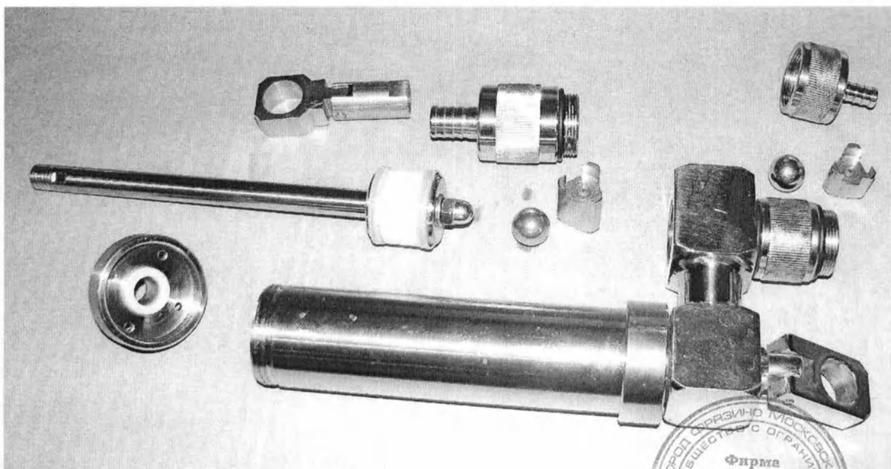
(рис. фото дозирующего насоса в разобранном виде - поэтапная разборка)
