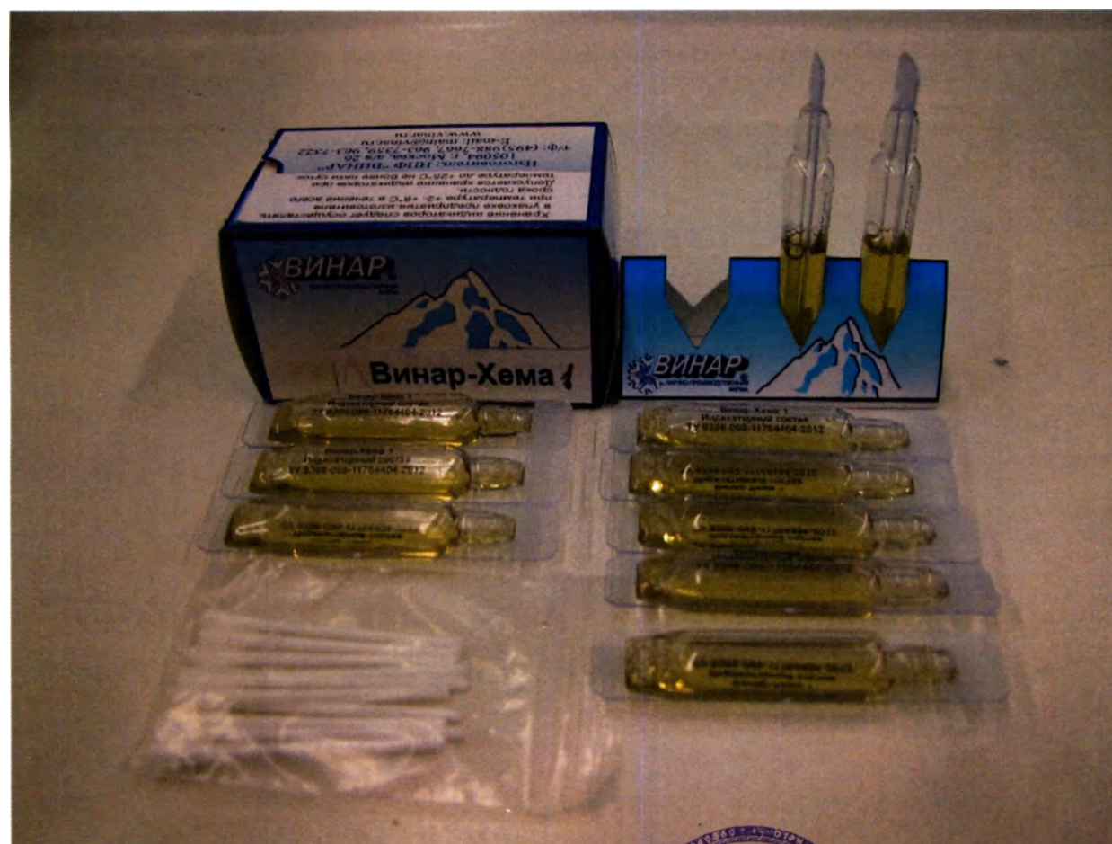
Индикаторы химические «Винар» контроля эффективности очистки инструментов «Винар-Хема 1»
