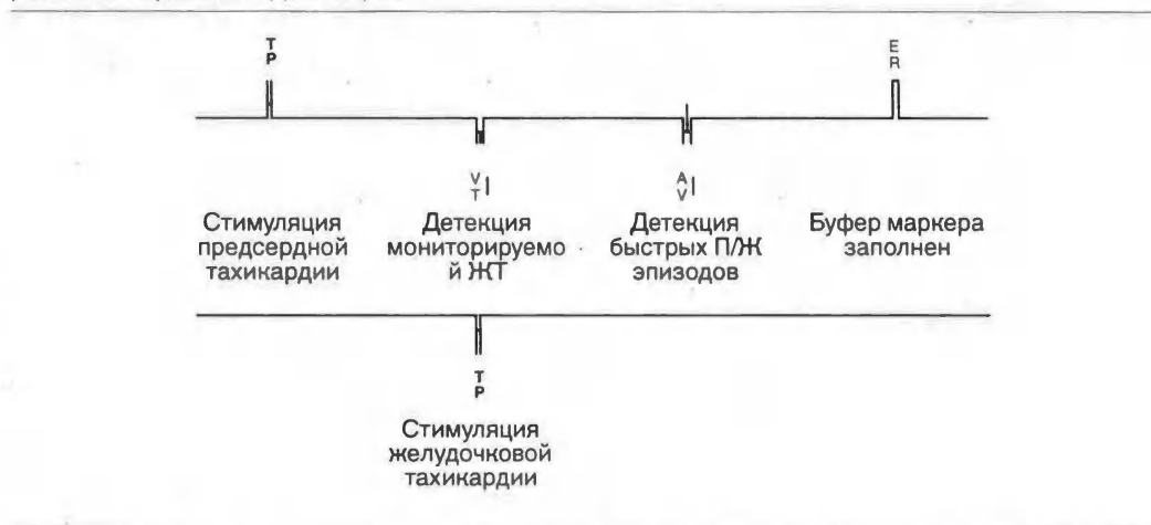
Рисунок 12. Аннотация и символы Marker Channel для выполняемых в ручном режиме терапий и детекции
