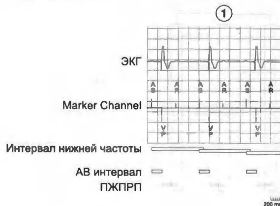
Рисунок 47. Пример стимуляции с частотой блока 2:1
