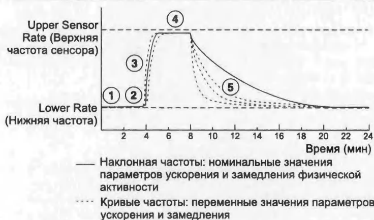
Рисунок 59. График влияния Activity Acceleration (Ускорение физической активности) и Activity Deceleration (Замедление физической активности) на частотную адаптацию
