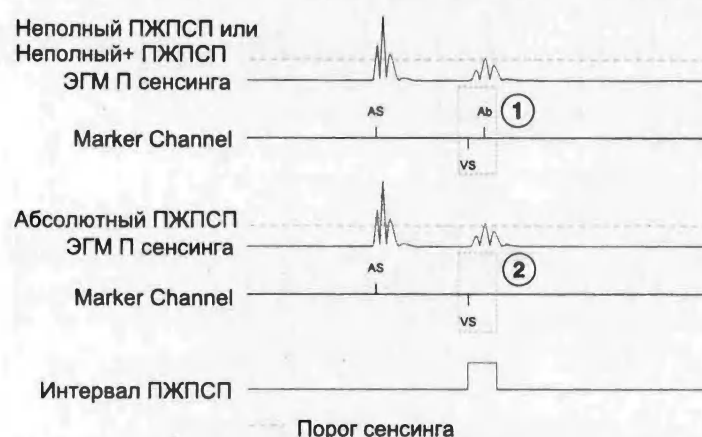
Рисунок 38. Сравнение методов ПЖПСП (монополярный предсердный сенсинг)
