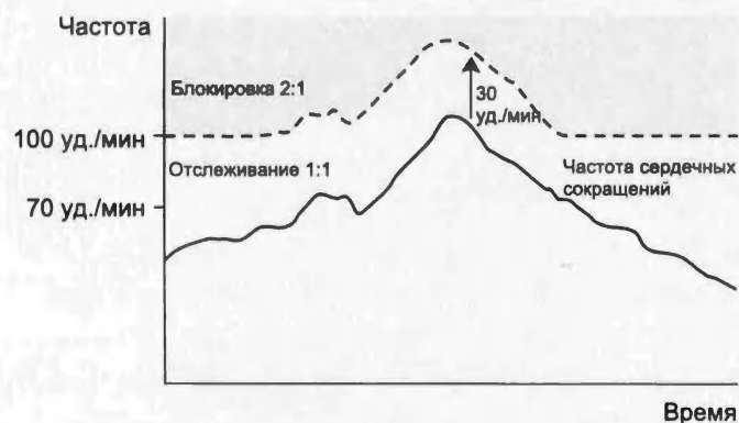
Рисунок 75. Действие параметра Auto PVARP (Автоматический ПЖПРП) в режиме DDDR или DDD
