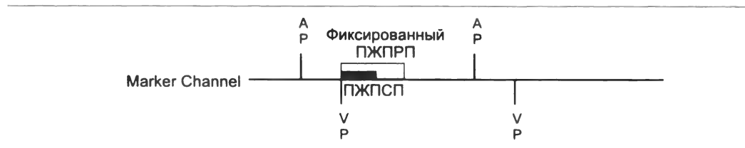
Рисунок 39. Синхронизация для фиксированного ПЖПРП
