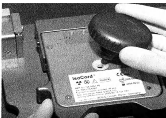
Установка ручки привода
