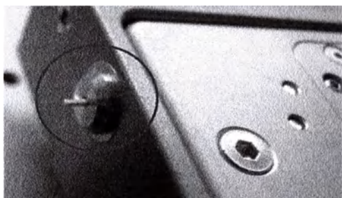
Половина вставки, выступающая из втулки
