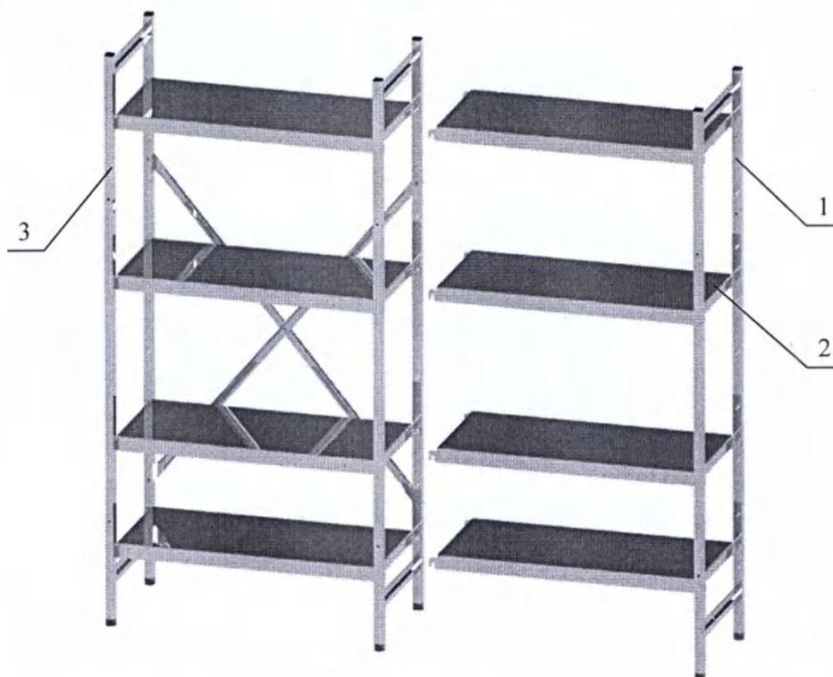
Рисунок 2. Схема сборки. 1 – рама; 2 – полка; 3 – стеллаж СМСК
