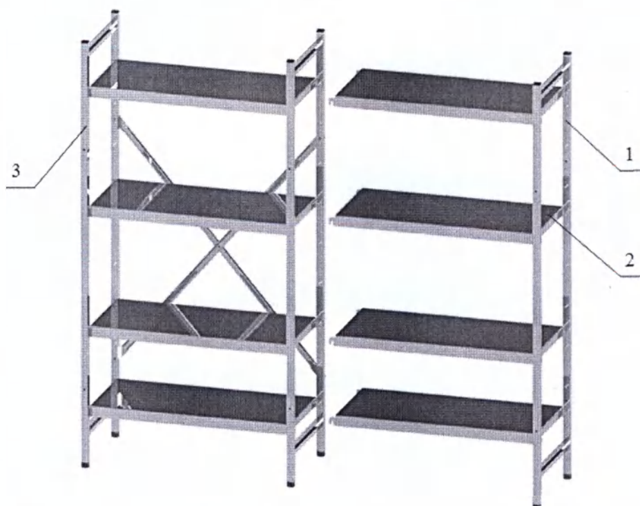
Рисунок 2. Схема сборки. 1 –рама; 2 – полка; 3 – стеллаж СМС
