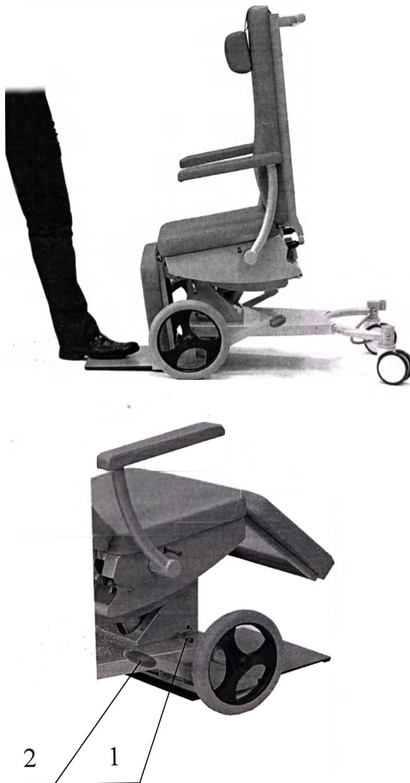
Рисунок 3 – Положение кресла при посадке и вставании пациента 1 – переключатель одновременного наклона сиденья и спинки; 2 – педаль гидравлического домкрата.
