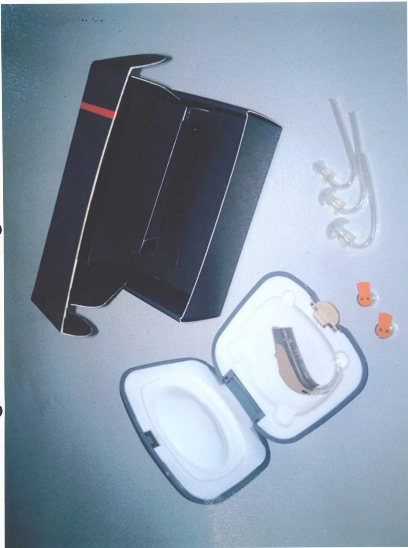
ФОТОГРАФИЯ АППАРАТА СЛУХОВОГО ЭЛЕКТРОННОГО ПРОГРАММИРУЕМОГО ВОЗДУШНОГО ЗВУКОПРОВЕДЕНИЯ ЗАУШНОГО ТИПА «ФОРМАНТА-Р» С ПРИНАДЛЕЖНОСТЯМИ : ЗВУКОПРОВОД №1, №2, №3; ЭЛЕМЕНТ ПИТАНИЯ 1,4 В, ТИП 13; ФУТЛЯР; КОРОБКА.
