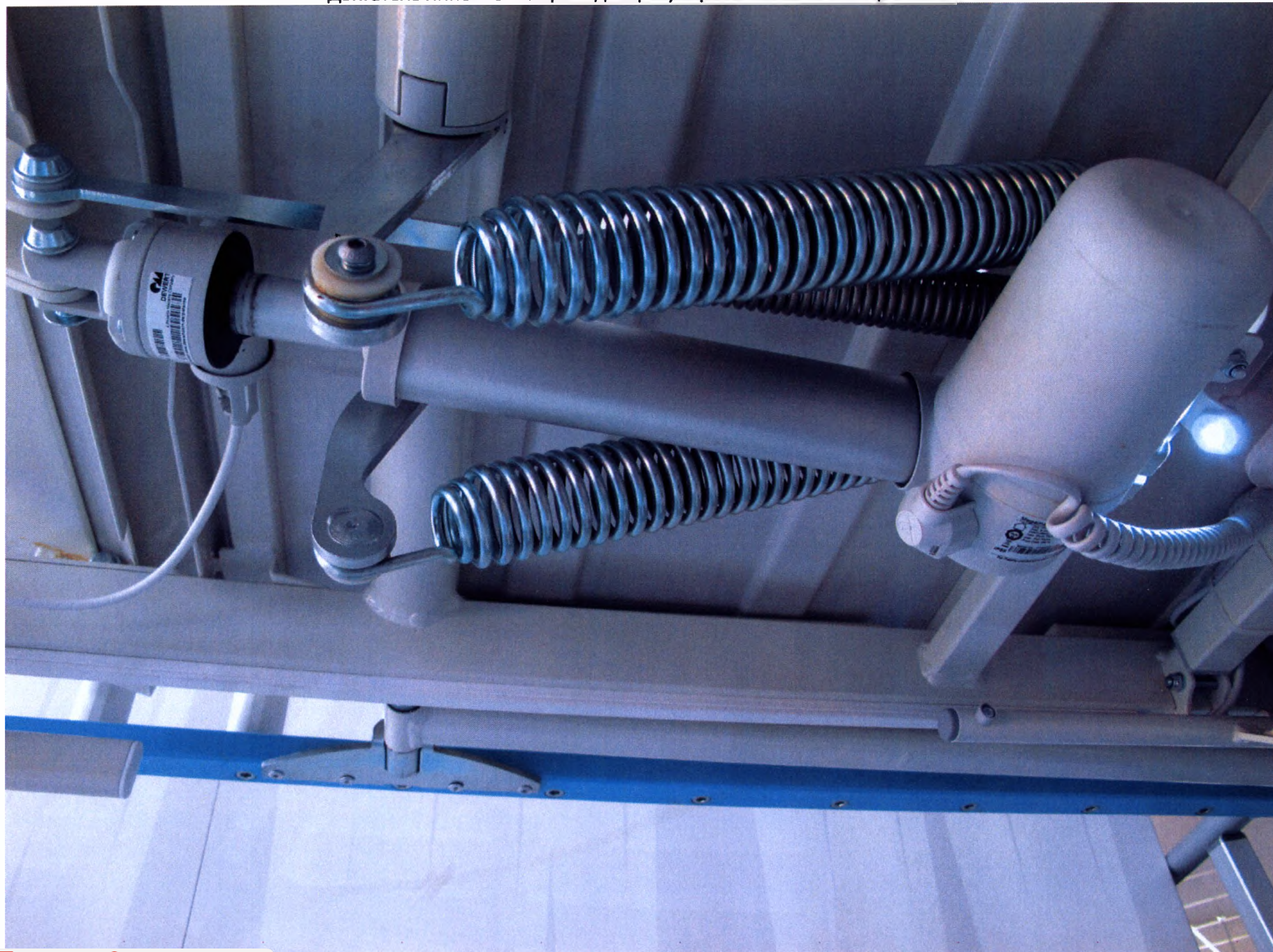
Двигатель линейный с приводом регулировки наклона секции ложа.
