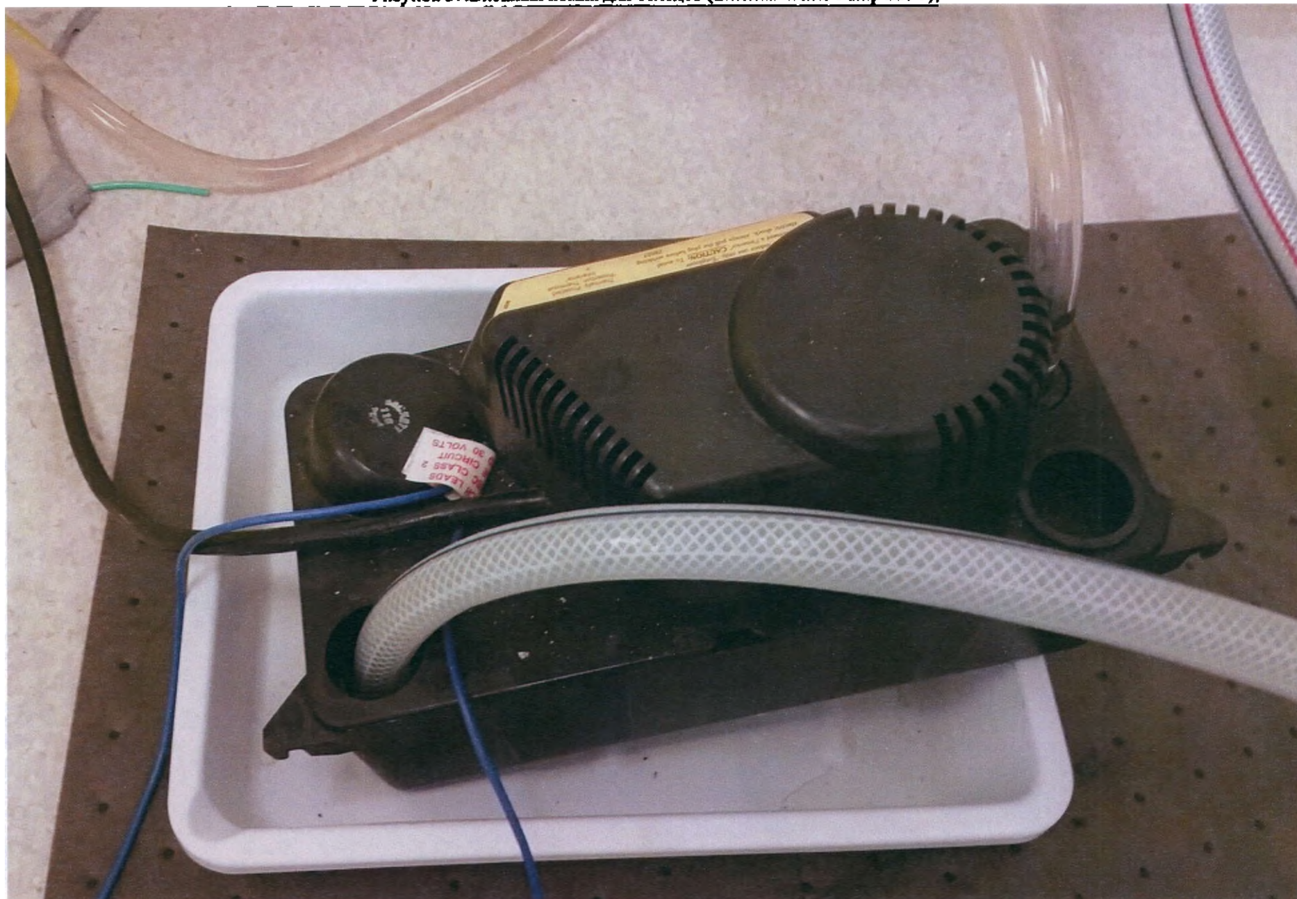
Рисунок 59. Внешняя помпа для отходов (External Waste Pump 220V);
