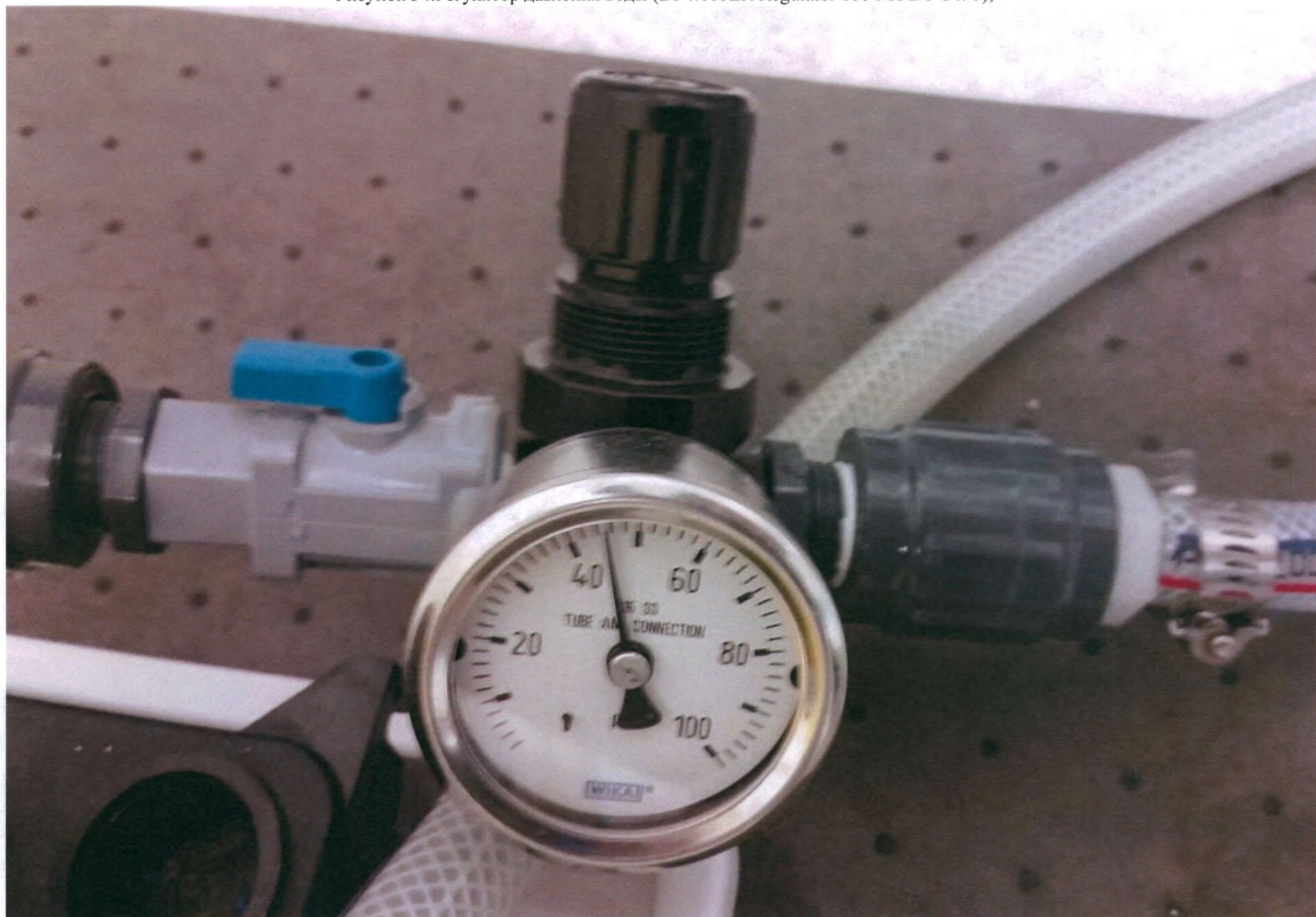
Рисунок 54.Регулятор давления воды (DI WATER Regulator 100 PSI BY SWT);
