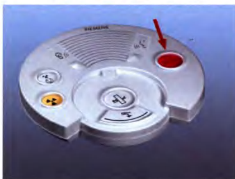
Кнопка СТОП (СТОП) на блоке управления
