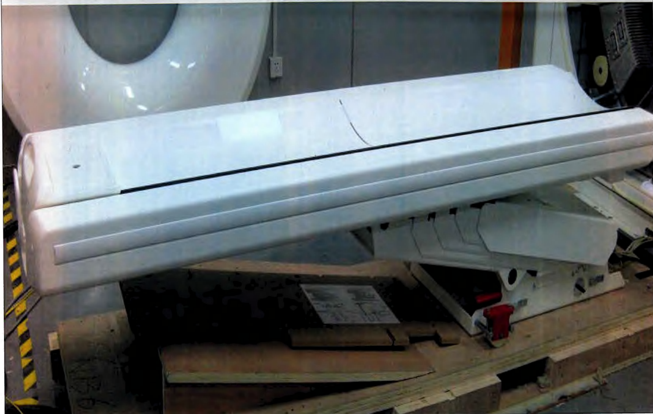
Рисунок 6. Стол пациента, варианты исполнения: стандартный, усиленный, удлиненный
