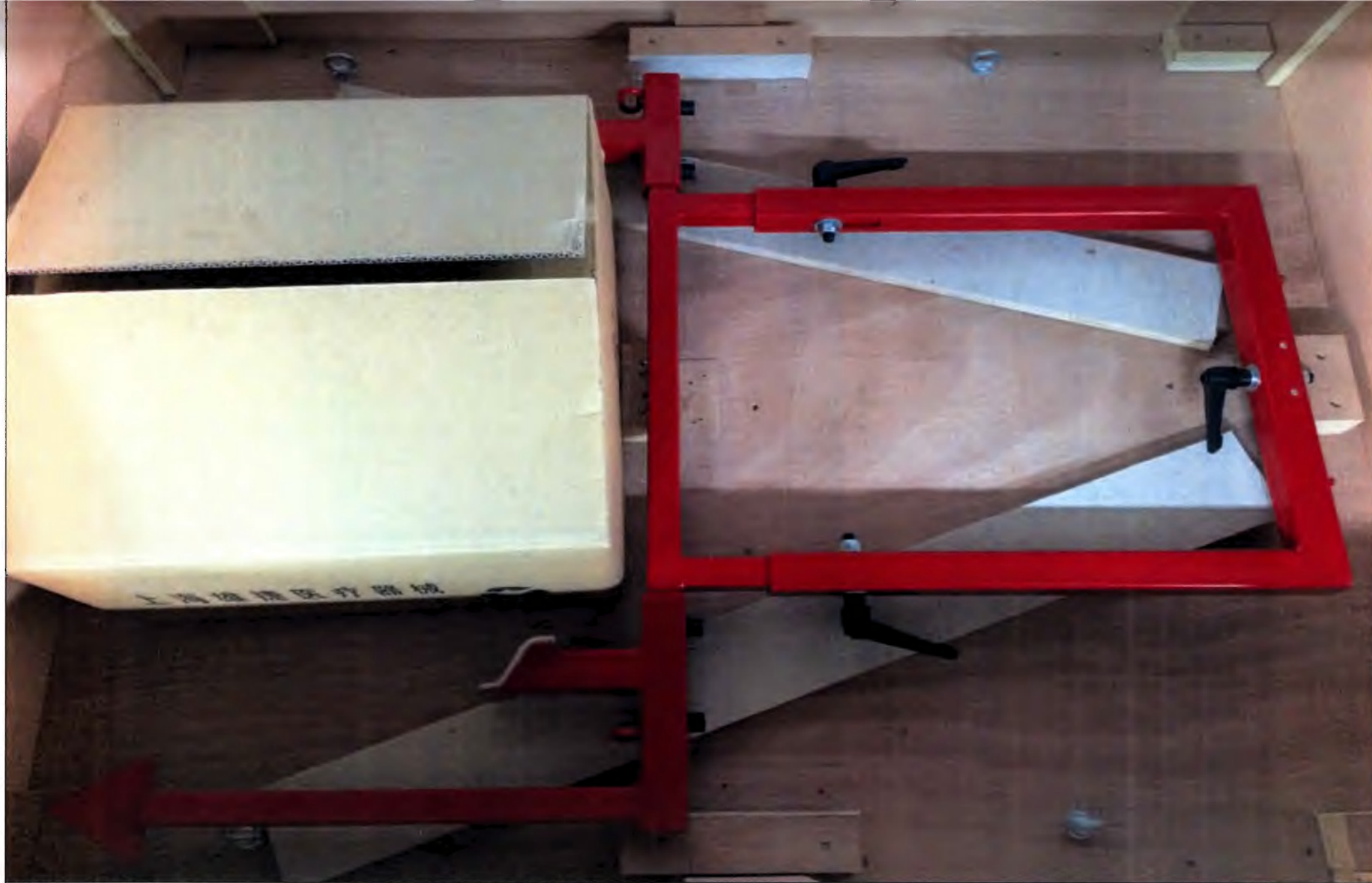
Рисунок 12а. Монтажные фиксаторы для крепления базового блока
