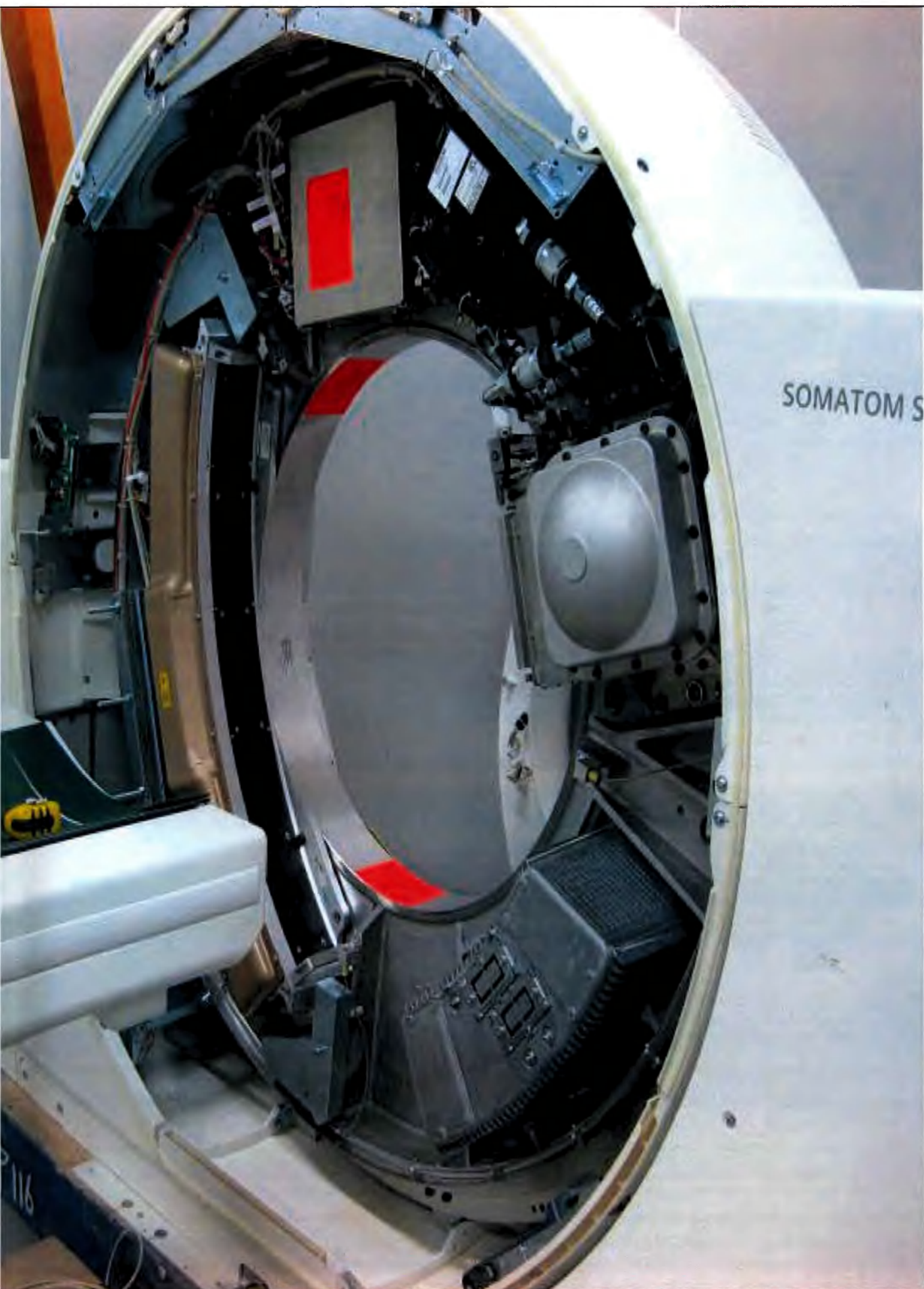
Рисунок 1. Гентри, основной блок, в составе: рентгеновская трубка, коллиматор, детектор, генератор, дисплей, панель управления гентри, переговорное устройство
