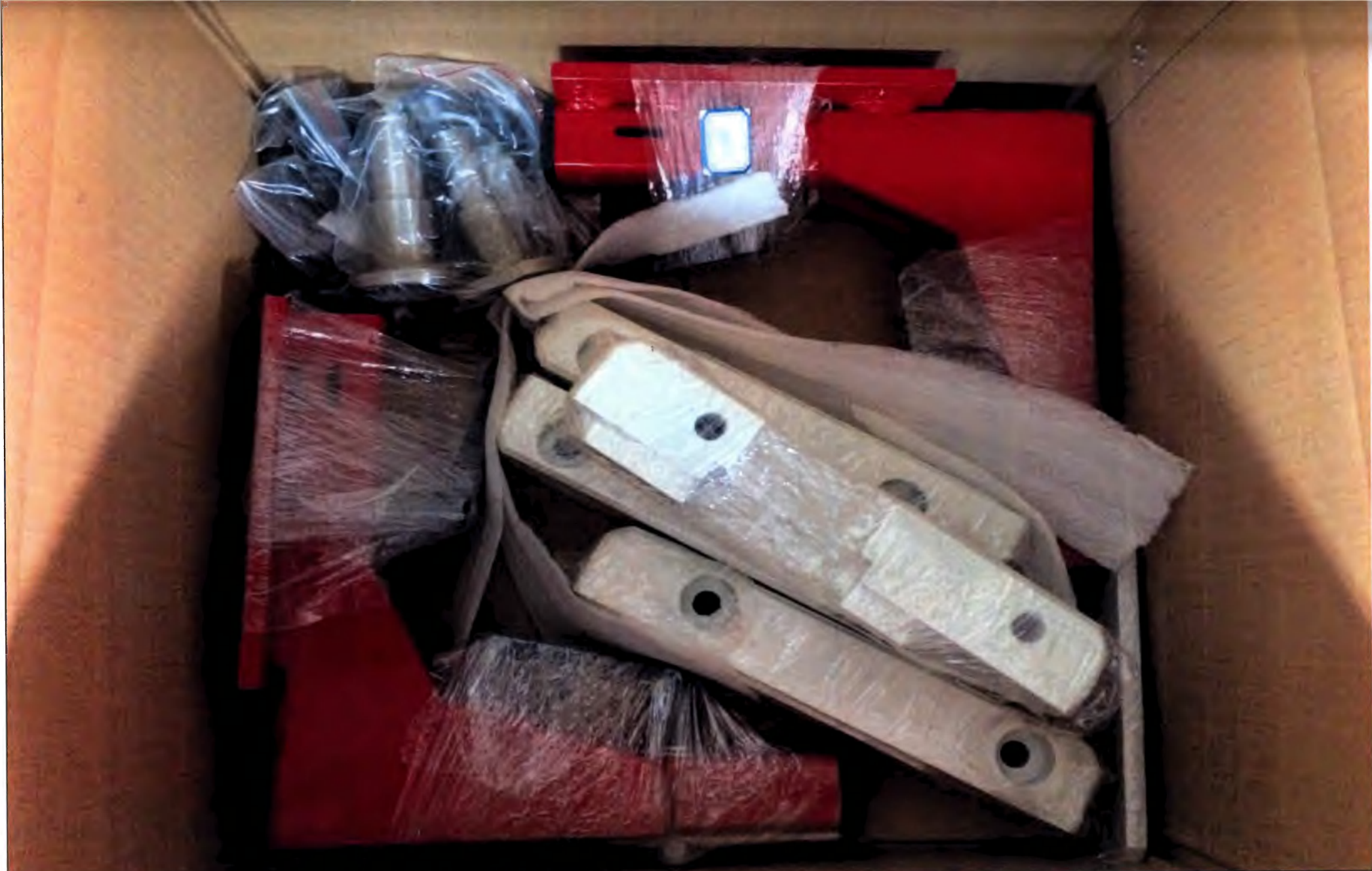
Рисунок 126. Монтажные фиксаторы для крепления базового блока
