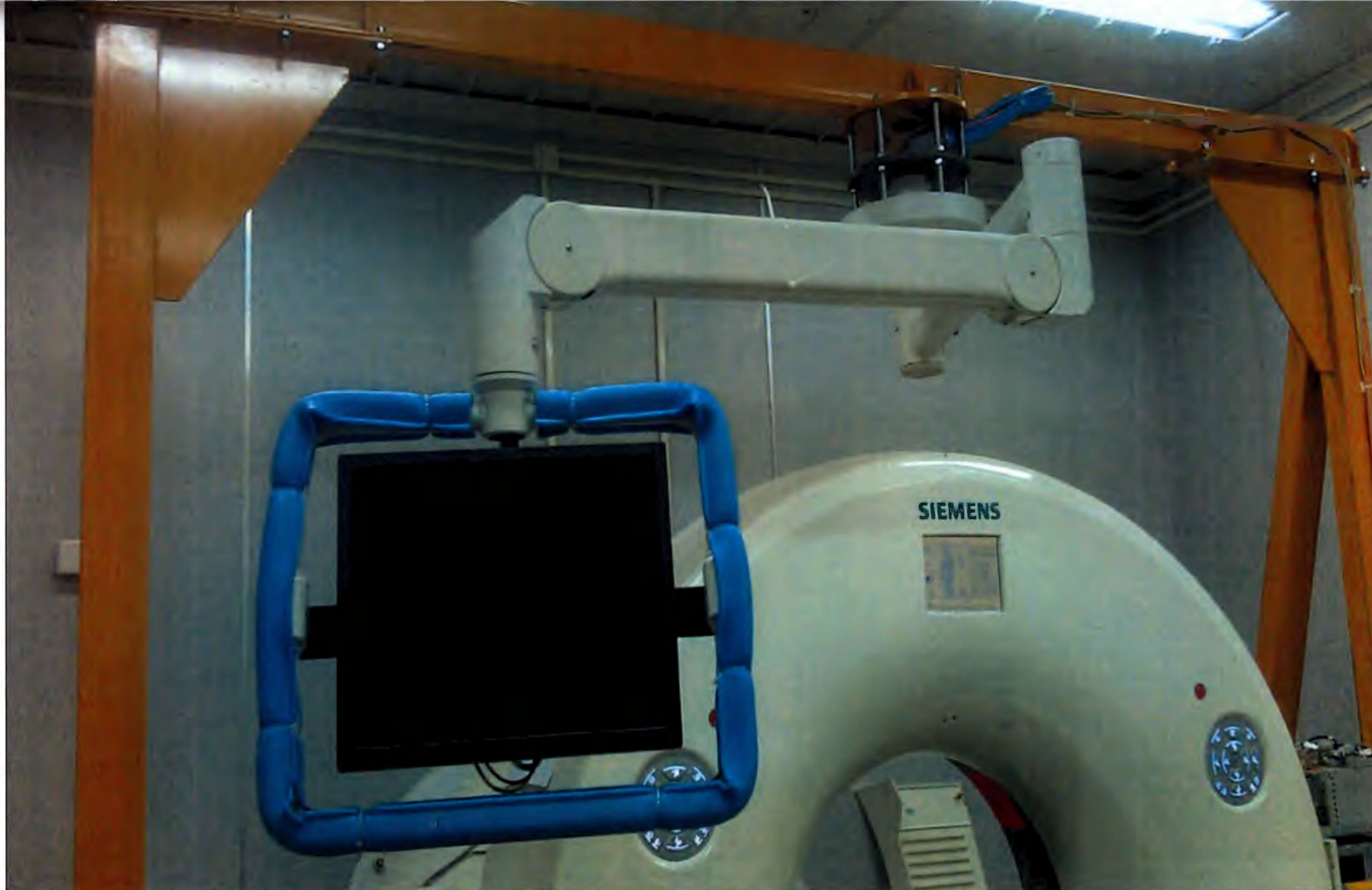
Рисунок 38. Комплект средств для установки монитора при потолочном креплении: - рычаги; - рамы; - кабели
