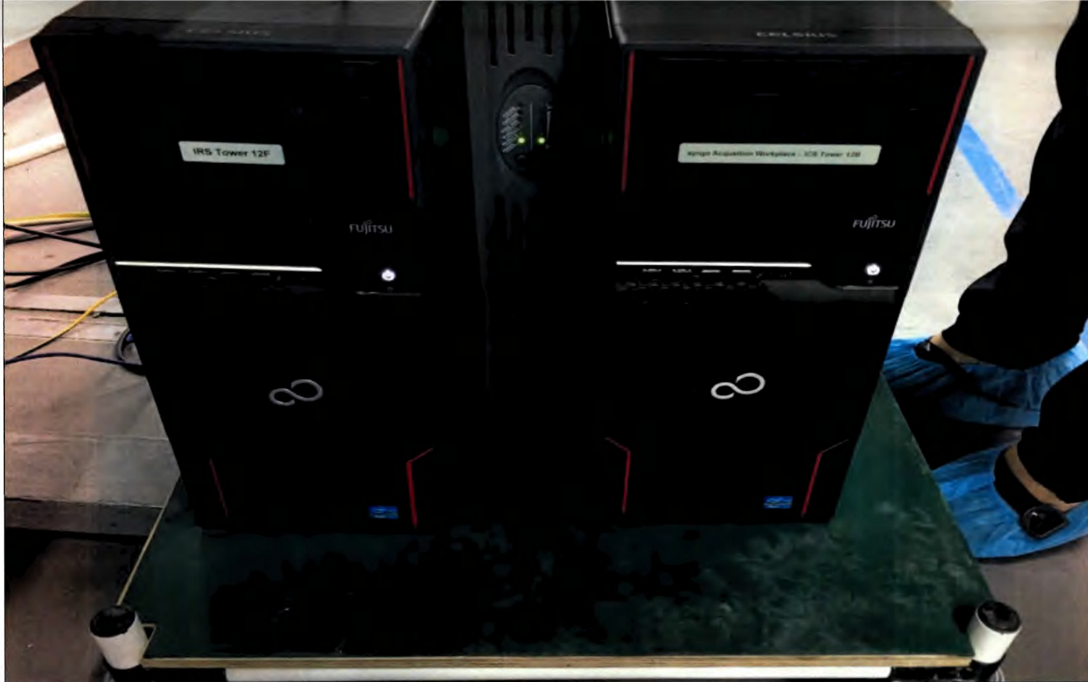
Рисунок 5. Система реконструкции изображений (варианты исполнения: стандартная, высокопроизводительная, улучшенная) в составе: - модуль управления сканированием; - модуль управления реконструкцией; - модуль анализа изображений
