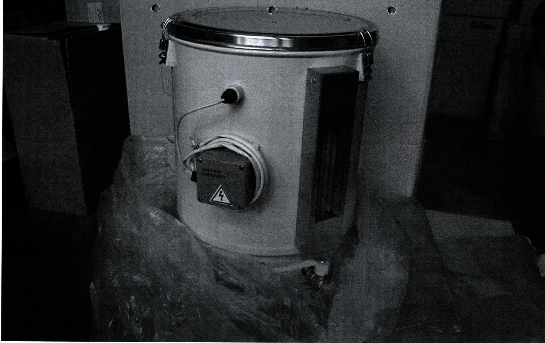
Сборник для воды очищенной вместимостью не менее 16 л
