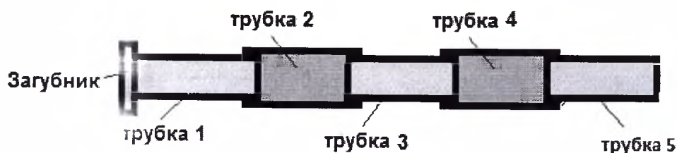
Рис. 1. Схема тренажера дыхательного индивидуального «MIRON-01», где трубка 1 - трубка d14, трубка 2 - трубка d16, трубка 3 - трубка d14, трубка 4 - трубка d16, трубка 5 - трубка d14.
