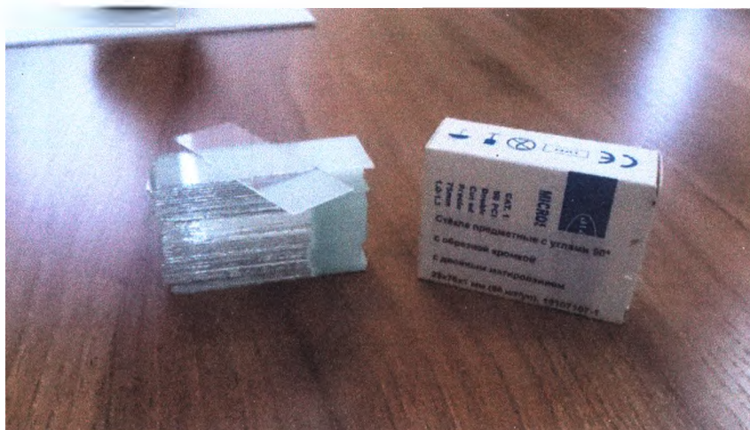
Стекла предметные с углами 90° с обрезной кромкой с двойным матированием 25x75x1 мм
