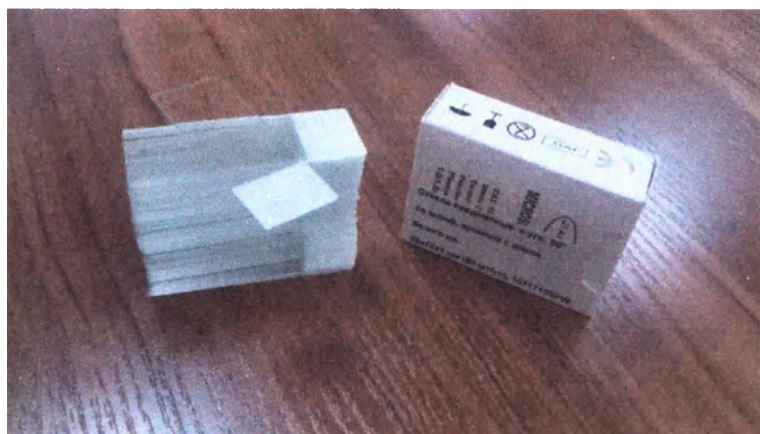
Стекла предметные с углами 90^\circ со шлифованной кромкой с зоной белого цвета 25x75x1 мм
