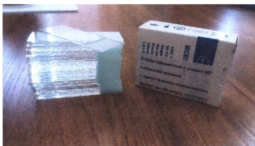
Стекла предметные с углами 90^\circ с обрезной кромкой с односторонним матированием 25x75x1 мм
