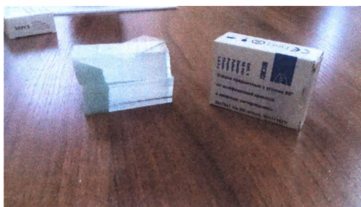
Стекла предметные с углами 90° со шлифованной кромкой с двойным матированием 25x75x1 мм
