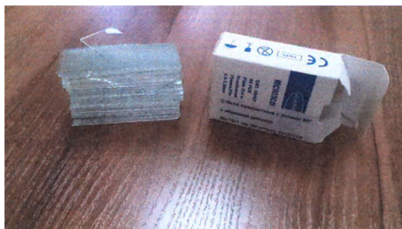
Стекла предметные с углами 90^\circ с обрезной кромкой 25x75x1 мм
