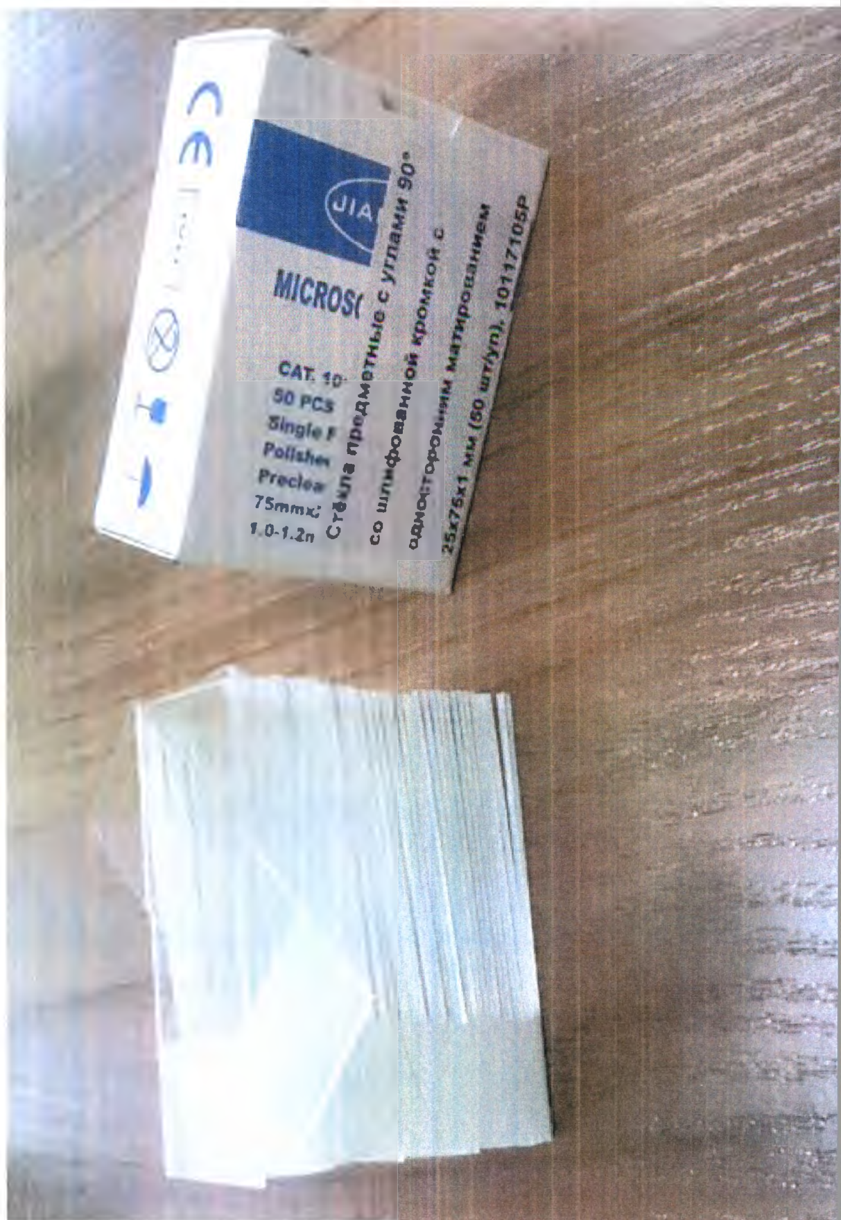
Стёкла предметные с углами 90° со шлифованной кромкой с односторонним матированием 25x75x1 мм
