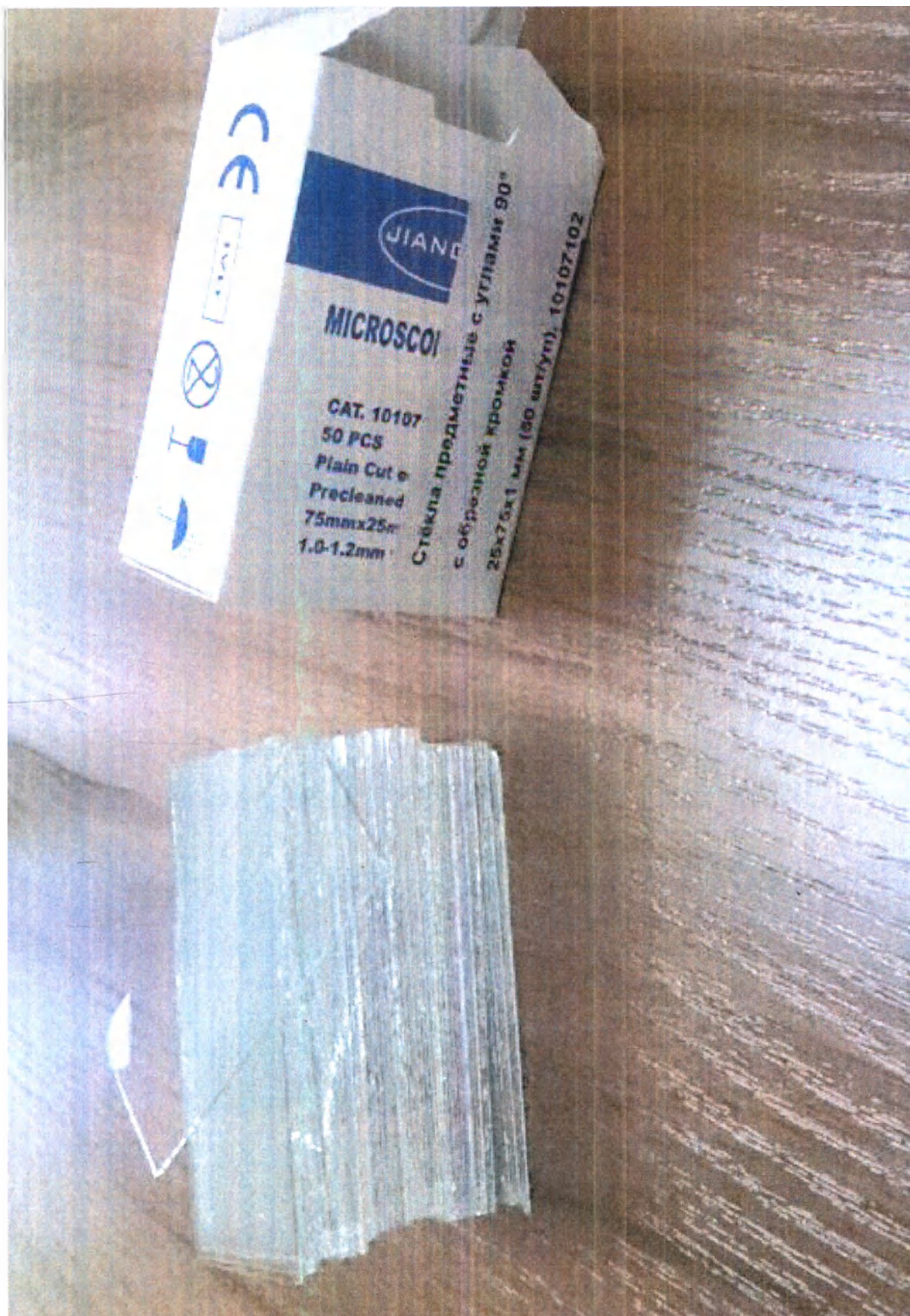
Стекла предметные с углами 90^\circ с обрезной кромкой 25x75x1 мм
