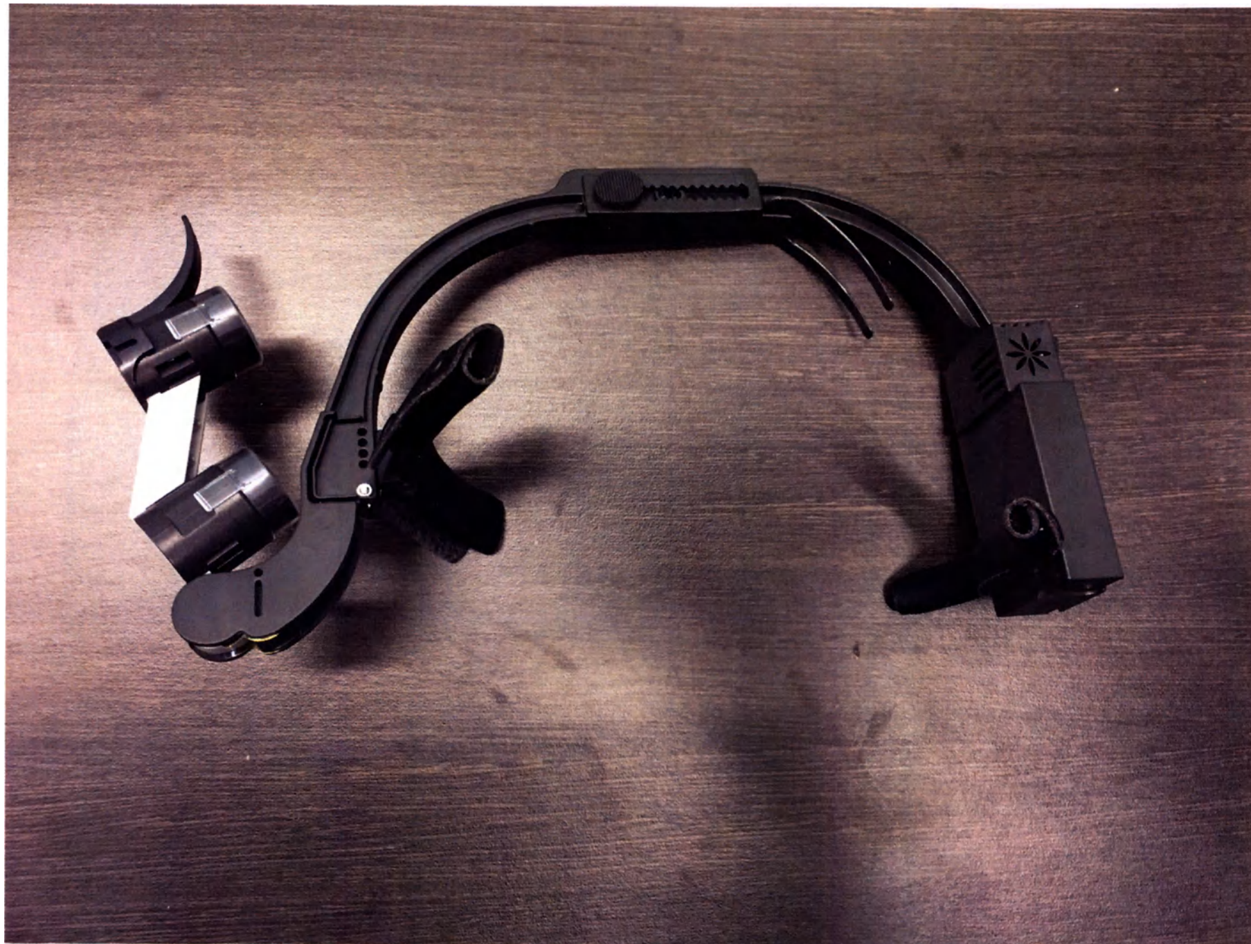
Осветитель медицинский налобный в различных вариантах исполнения (Осветитель с LED источником )
