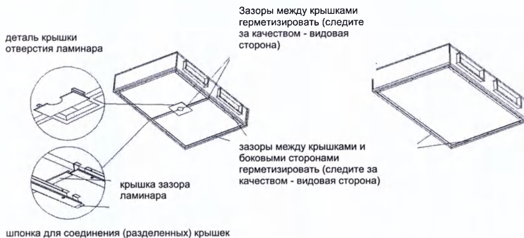
ДЕТАЛЬ СОЕДИНЕНИЯ КРЫШЕК И РАЗМЕЩЕНИЯ КРЫШКИ ЗАЗОРА ЛАМИНАРА
