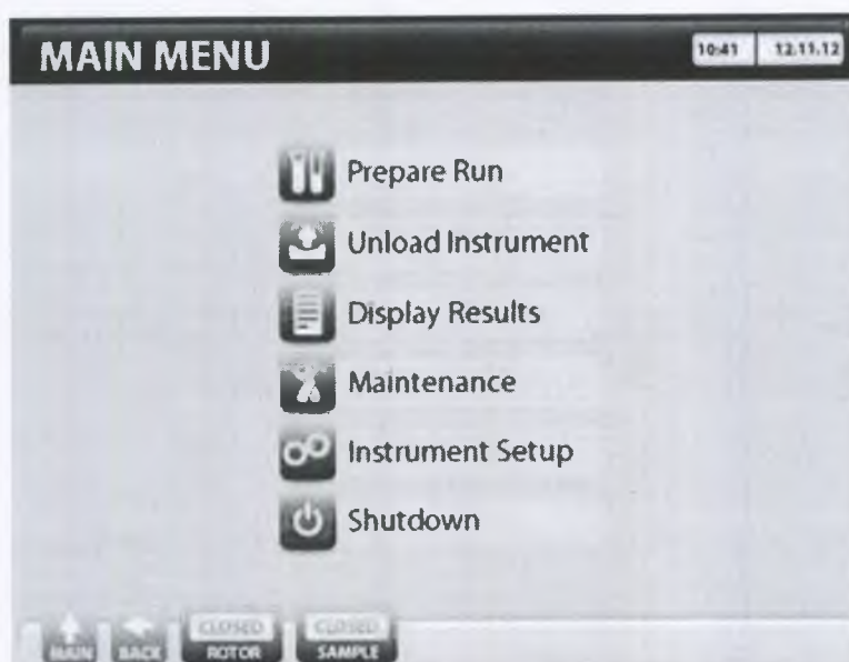
Рисунок 3-3. Главное меню. Выбор опций: подготовка теста, разгрузка, показать результаты, обслуживание, настройка прибора, выключение. Для перехода к подменю нажать соответствующую клавишу.
