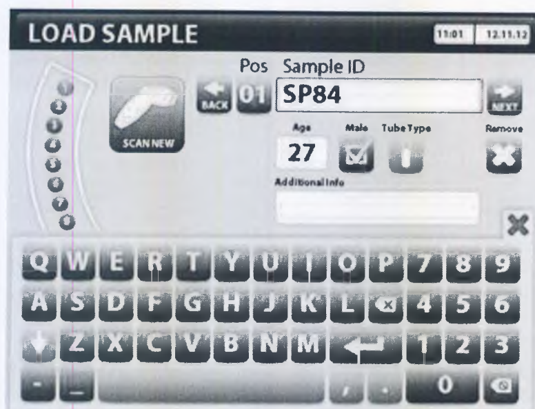
Рисунок 3-10. При нажатии на окно ввода на экран выводится клавиатура. Ввод подтверждается клавишей
