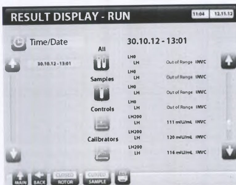
Рисунок 3-21. Экран результатов анализов. Представлены сведения о нарушениях предельно допустимых показателей для тестовых/контрольных образцов.
