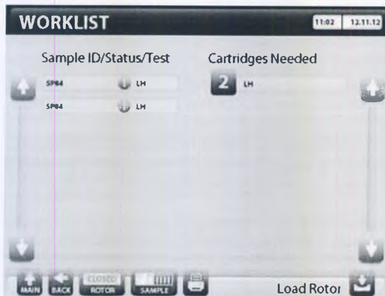
Рисунок 3-12. Подменю загрузки. Справа – перечень необходимых картриджей. Слева – дополнительные сведения об образцах и назначенных тестах.
