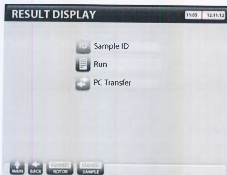
Рисунок 3-20. Экран ручного доступа – показаны опции дисплея результатов.
