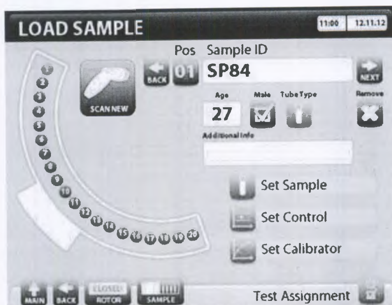
Рисунок 3-9. Экран загрузки образцов для ввода вручную/сканирования образцов. Для навигации по образцам использовать клавиши со стрелками (расположены возле окна ввода). Обзор загруженных образцов (зеленый – ячейка занята, синий – текущая загрузка, серый – пустая ячейка).
