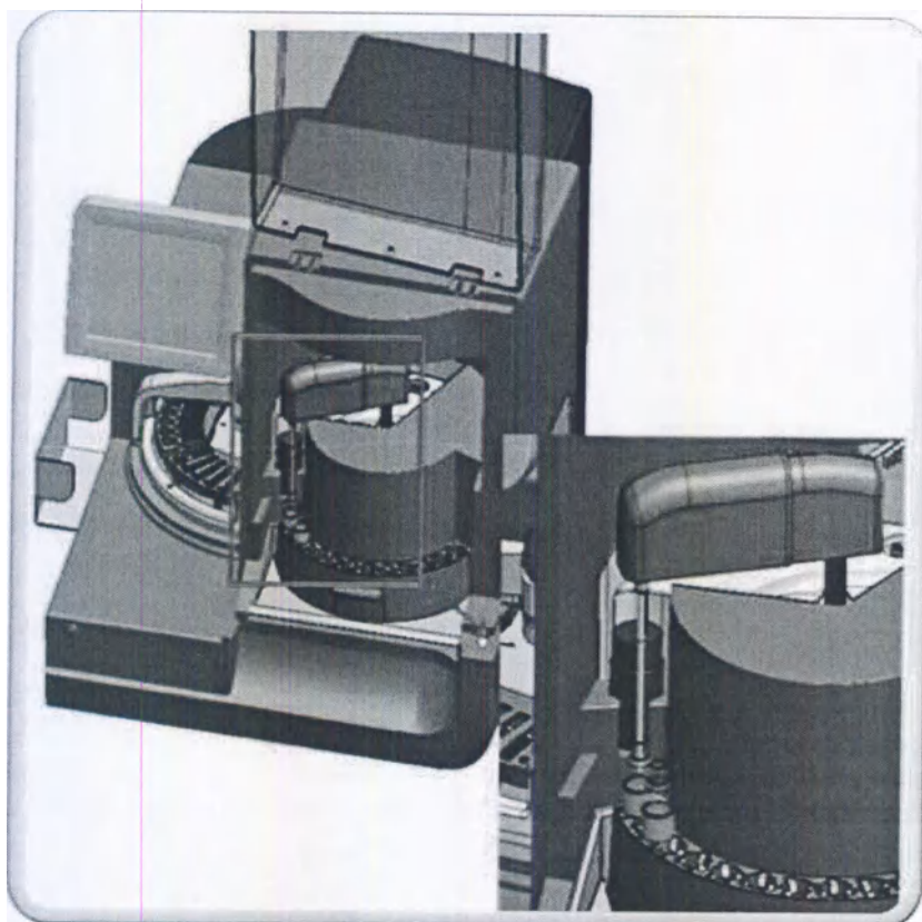
Рисунок 1-4. Блок пипетки и дуга для образцов. Справа показан блок пипеток в процессе аспирации контрольного/калибровочного образца. Для размещения контрольных/калибровочных проб на дуге образцов для основных пробирок используется адаптер.
