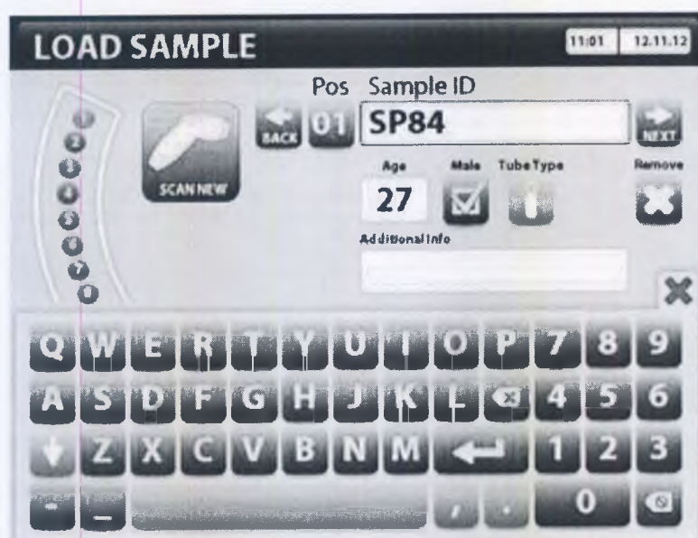
Рисунок 3-10. При нажатии на окно ввода на экран выводится клавиатура. Ввод подтверждается клавишей "Enter". Для скрытия клавиатуры и сохранения введенной информации, нажать на красный крест.
