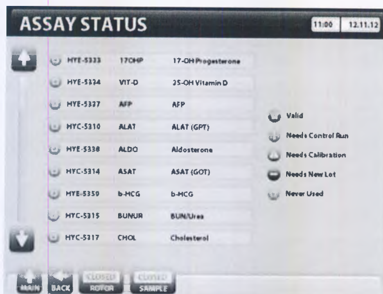
Рисунок 3-8. Подробное описание тестов, загруженных в прибор DRG:HYBRiD.XL®. Значение символов:
