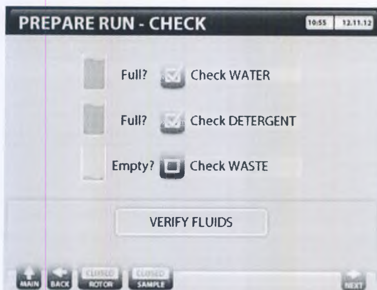
Рисунок 3-4. Контрольный экран подготовки к работе. Для продолжения, вручную подтвердить заполнение бутылей с рабочими жидкостями. Прибор автоматически проверит состояние ротора.
