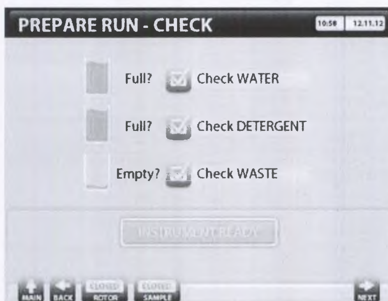
Рисунок 3-5. Экран после успешной проверки ротора и подтверждения заполнения бутылей с рабочими жидкостями. Для продолжения нажать NEXT .
