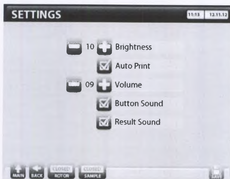
Рисунок 3-28. Экран основных настроек. Возможна настройка яркости экрана и громкости, конфигурация автоматической распечатки результатов после окончания анализов, активация/инактивация звуковых сигналов при нажатии клавиш.
