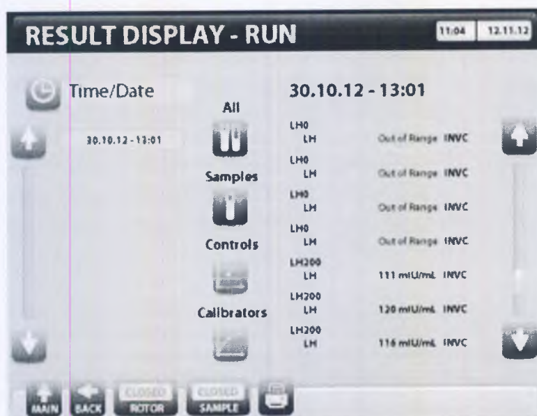
Рисунок 3-18. Экран результатов после завершения анализов; отображается информация о соответствующих образцах и нарушениях предельных показателей.
