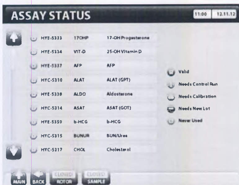
Рисунок 3-8. Подробное описание тестов, загруженных в прибор DRG:HYBRiD.XL®. Значение символов: = загружены валидные контрольные образцы; = требуются контрольные образцы; = требуется калибровка; = требуется новая партия тестов; = на приборе тест еще не проводился.
