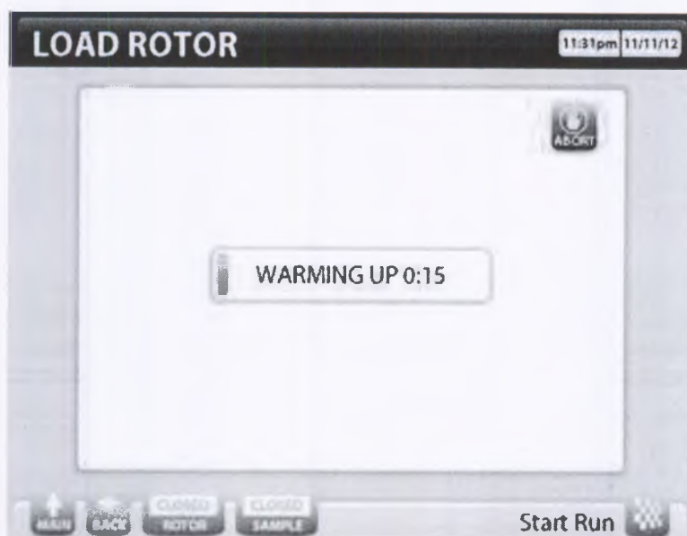
Рисунок 3-14. Фаза разогрева. Отображается время, оставшееся до начала теста (в минутах и секундах).
