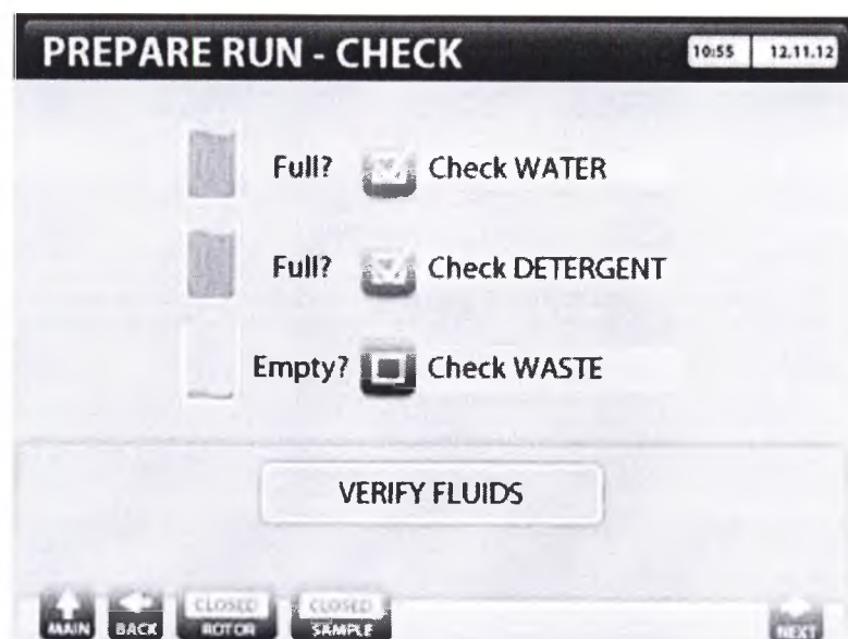
Рисунок 3-4. Контрольный экран подготовки к работе. Для продолжения, вручную подтвердить заполнение бутылей с рабочими жидкостями. Прибор автоматически проверит состояние ротора.
