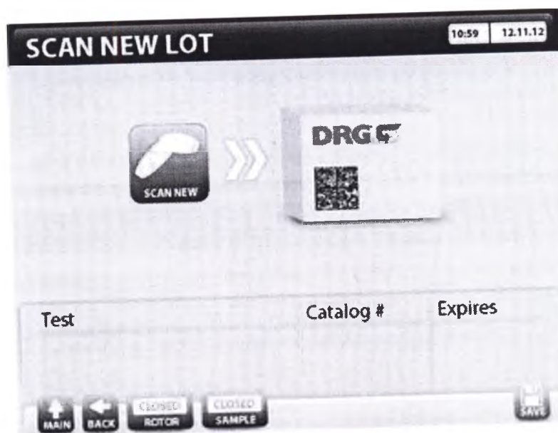
Рисунок 3-7. Сканирование новых партий тестов. После сканирования, выводится информация о тесте, номере части и сроке годности.
