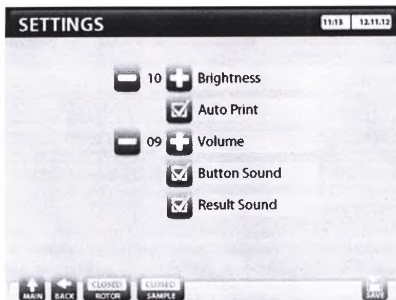
Рисунок 3-28. Экран основных настроек. Возможна настройка яркости экрана и громкости, конфигурация автоматической распечатки результатов после окончания анализов, активация/инактивация звуковых сигналов при нажатии клавиш.
