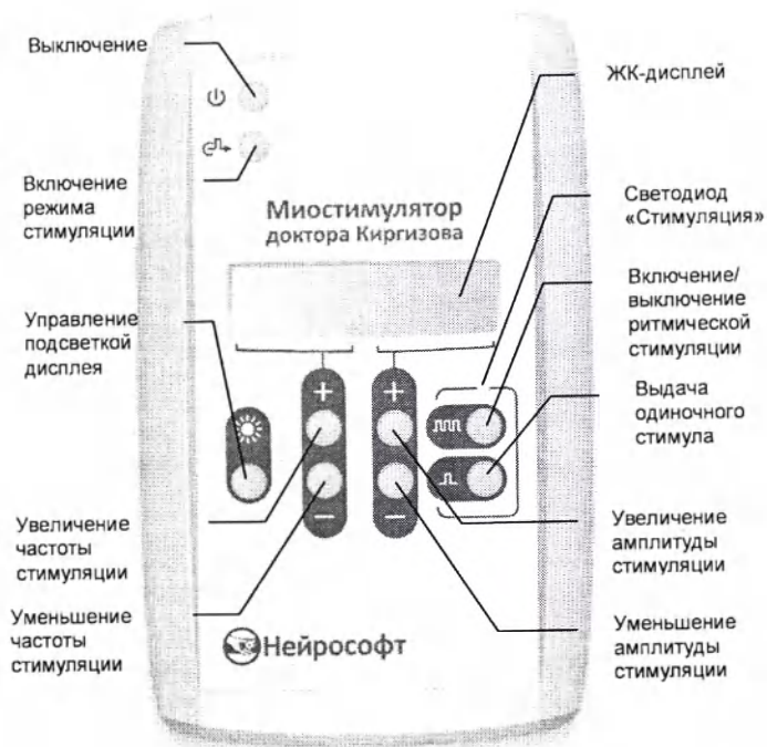
Рис. 2. Внешний вид передней панели электронного блока
