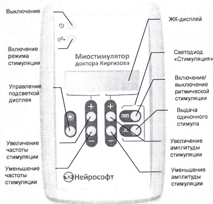
Рис. 2. Внешний вид передней панели электронного блока
