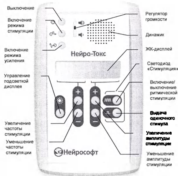
Рис. 2. Внешний вид передней панели электронного блока
