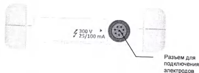
Рис. 3. Внешний вид торцевой панели электронного блока
