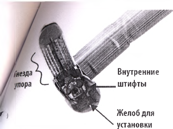
Рисунок 12 - Ополосните и протрите захваты для удаления незажатых скоб
