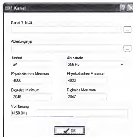
Рис. 7-47: Настройка передачи EDF+ Export для канала ECG
