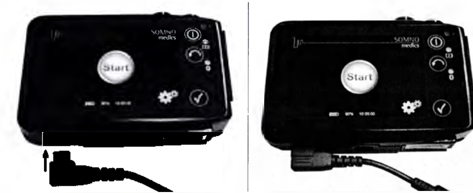
Подключение штекера датчика SpO 2 к основному устройству
