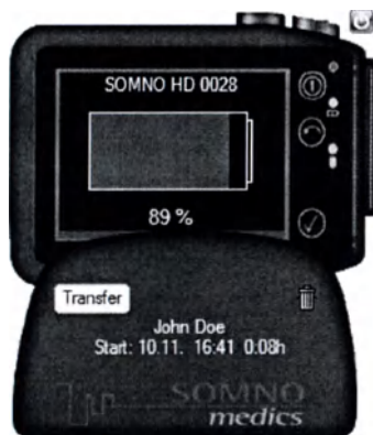
Виртуальная док-станция на мониторе ПК, если основное устройство подключено и измерение инициализировано
