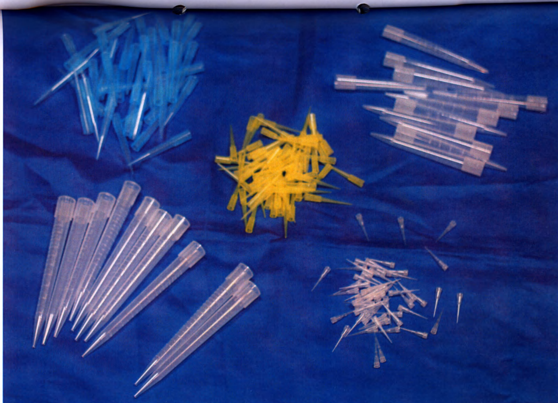
1. Наконечники универсальные для лабораторных дозаторов, объемом от 0,1 мкл до 10 мл, стерильные и нестерильные, упакованные в пакеты и штативы (наконечники рассыпью).
