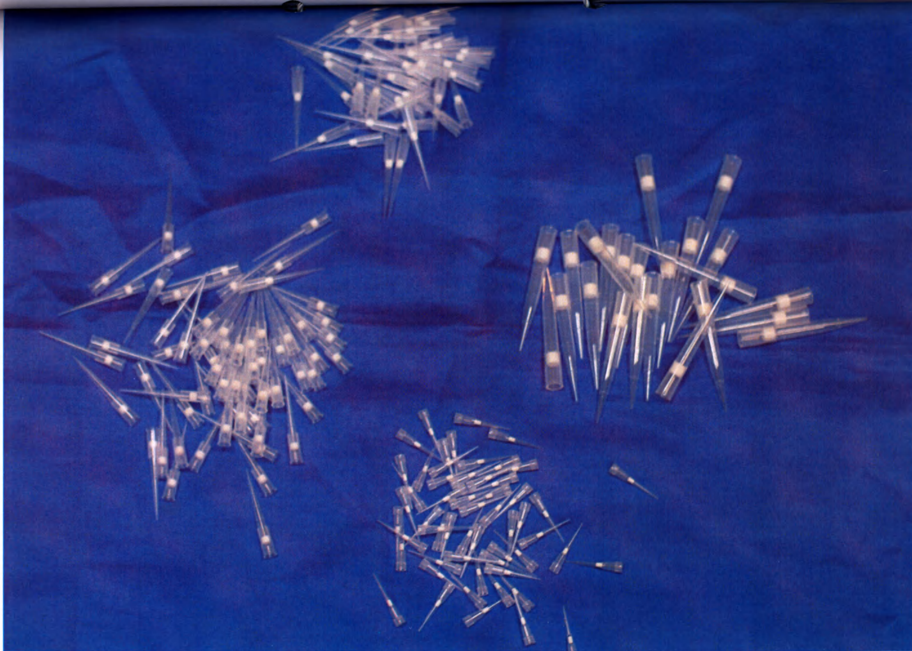
2. Наконечники универсальные с фильтром, для лабораторных дозаторов, объемом от 0,1 мкл до 10 мл, стерильные и нестерильные, упакованные в пакеты и штативы (наконечники рассыпью).
