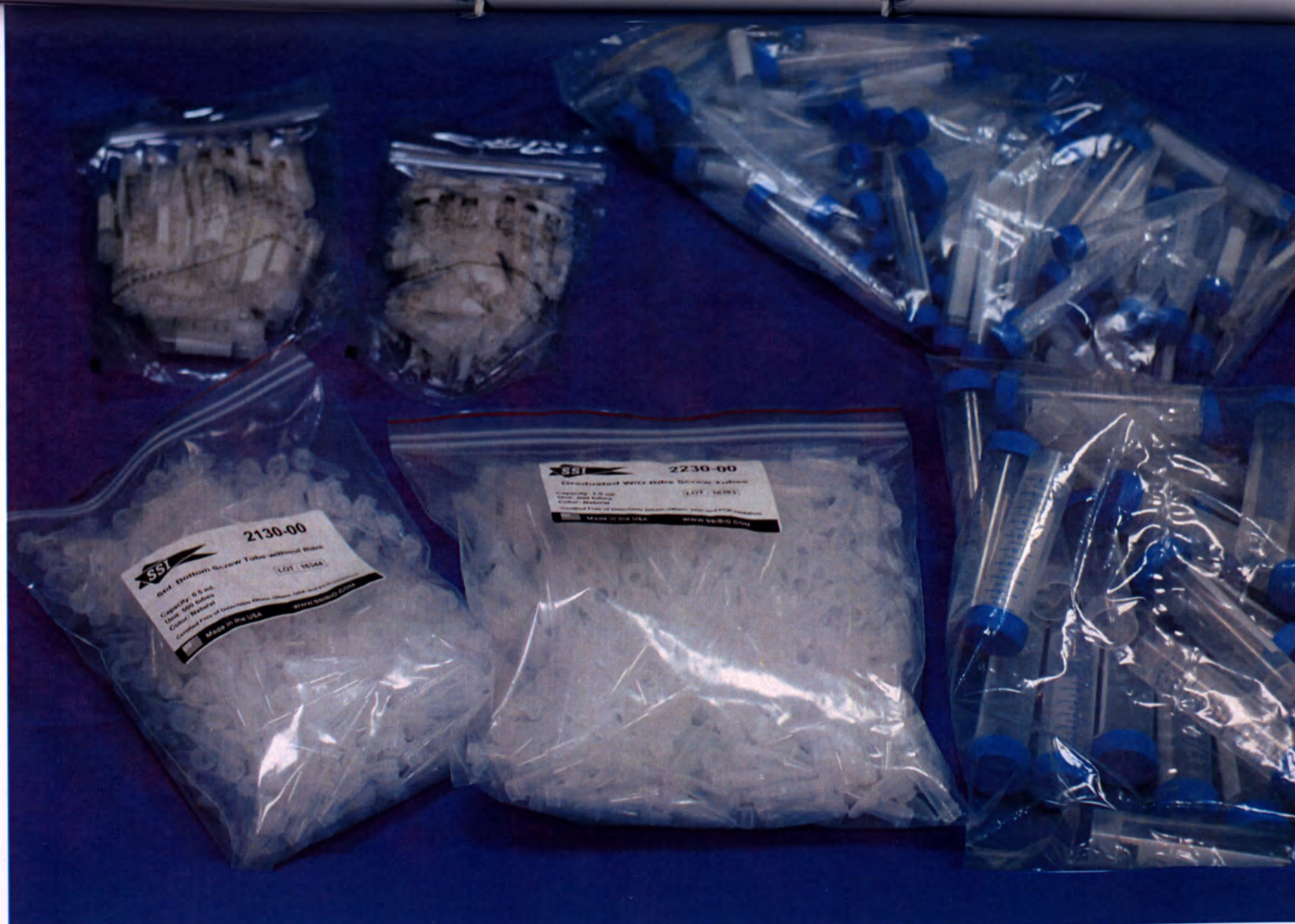
8. Пробирки для хранения и транспортировки проб и образцов, завинчивающиеся, конические и с основанием, с крышками и без крышек, объемом от 0,5 мл до 50 мл, упакованные в пакеты и штативы (пробирки в пакетах).
