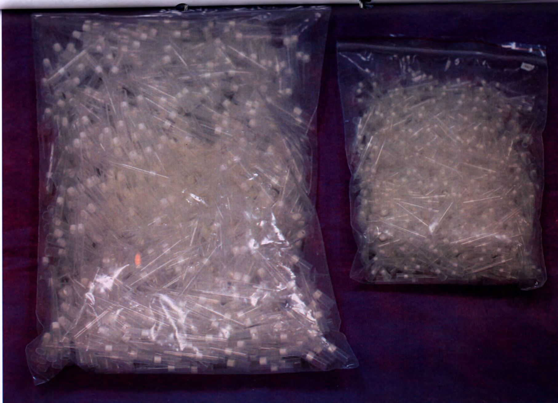
2. Наконечники универсальные с фильтром, для лабораторных дозаторов, объемом от 0,1 мкл до 10 мл, стерильные и нестерильные, упакованные в пакеты и штативы (наконечники, упакованные в пакеты).
