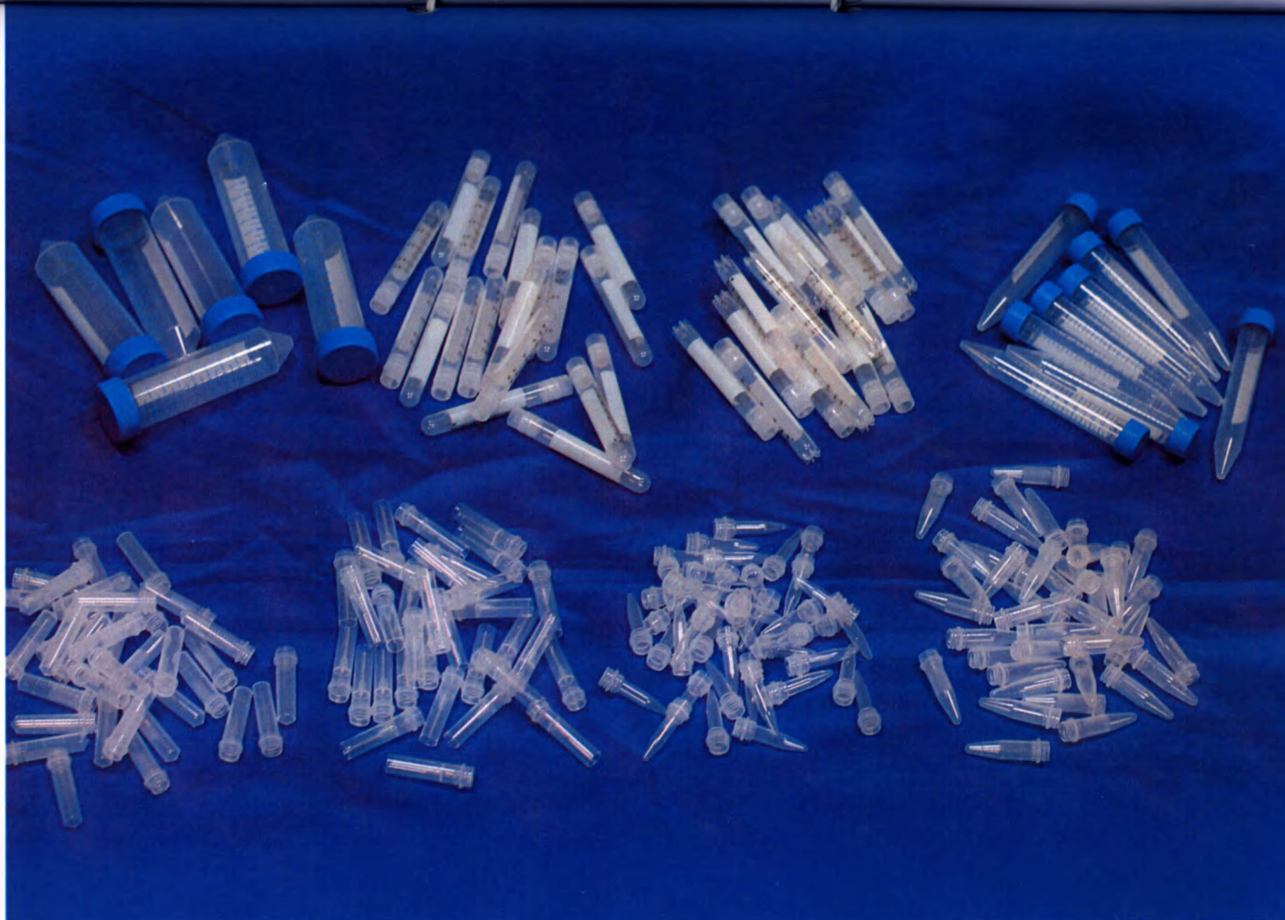
8. Пробирки для хранения и транспортировки проб и образцов, завинчивающиеся, конические и с основанием, с крышками и без крышек, объемом от 0,5 мл до 50 мл, упакованные в пакеты и штативы (пробирки россыпью).
