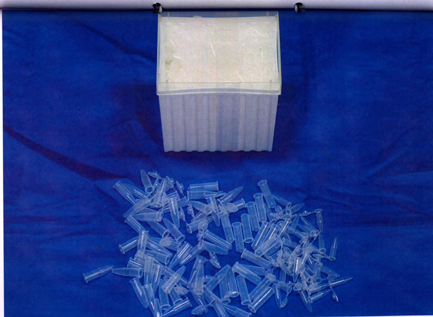
5. Пробирки микроцентрифужные объемом от 0,2 мл до 2,0 мл, с крышками и без крышек, стерильные и нестерильные, градуированные и неградуированные, упакованные в пакеты и герметичные коробки (пробирки, упакованные в герметичные коробки).
