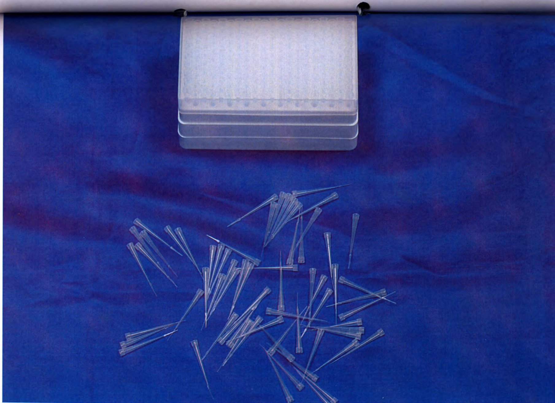
3. Наконечники для нанесения на гель, для лабораторных дозаторов, объемом от 0,1 до 300 мкл, стерильные и нестерильные, упакованные в штативы
