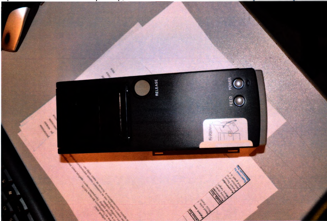
Термический точечный принтер, 191мм×270мм×100мм вес 1080 грамм материал ПВХ
