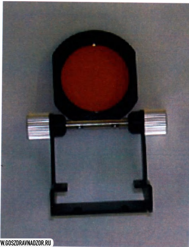
Желтый светофильтр Ободок сталь, оптика стекло, размер 3.5 на 3 см
