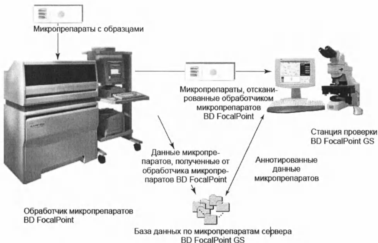
Рис. 2. Общая схема функционирования системы BD Focal Point GS Imaging.
