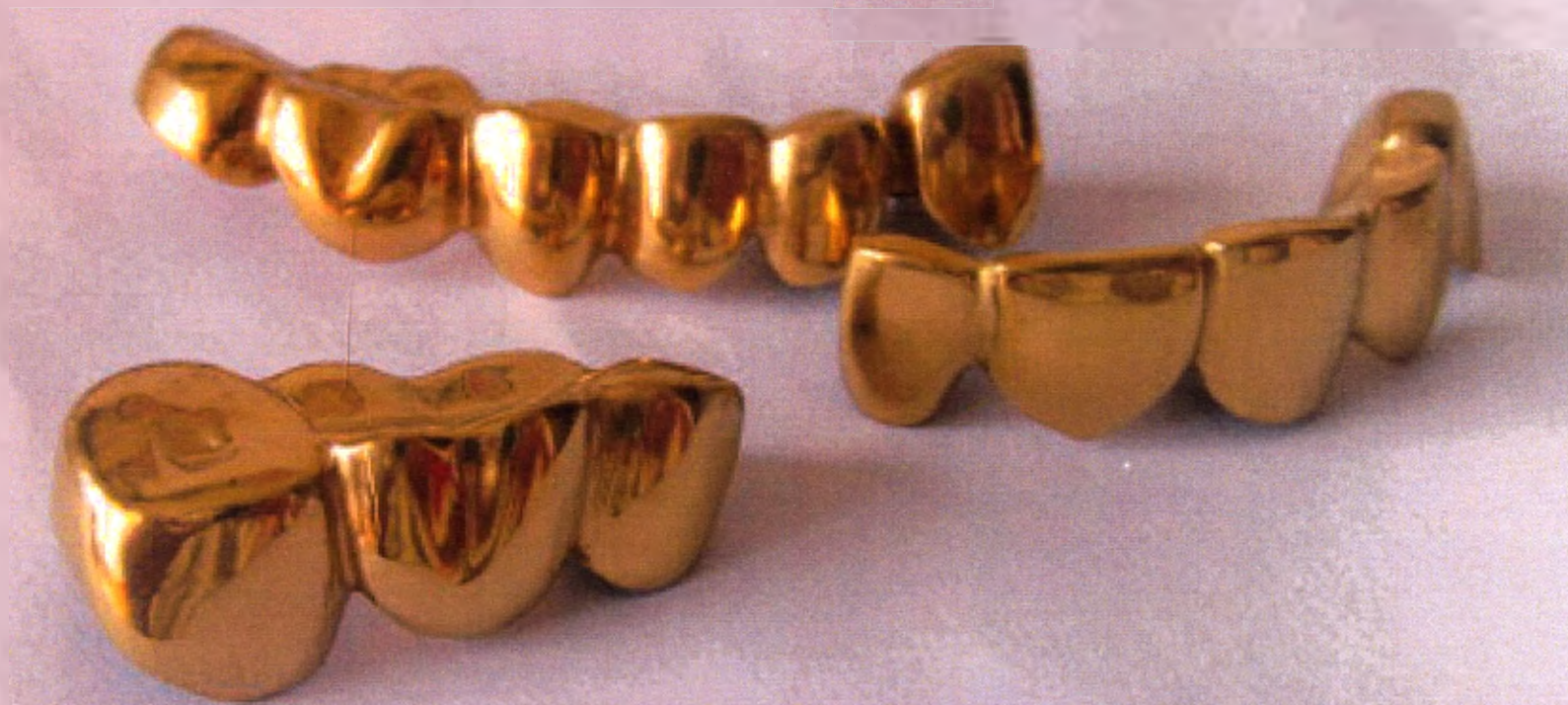
Фото 1 - Покрытие защитно-декоративное нитрид-титановое на металлических зубных протезах.
