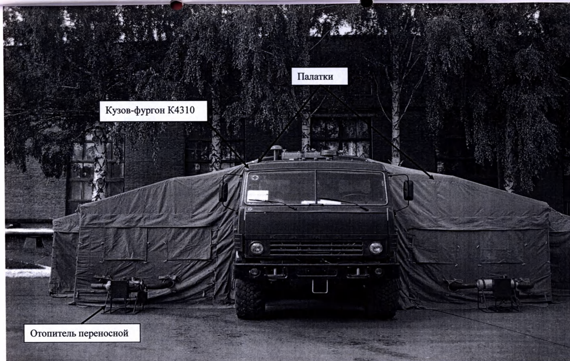
Фотография 1. Автоперевязочная АП-2-«СЗМО» в кузове-фургоне К4310 на шасси автомобиля КАМАЗ 43114 по ТУ 9451-004-07614018-2008. Общий вид. Рабочее положение.
