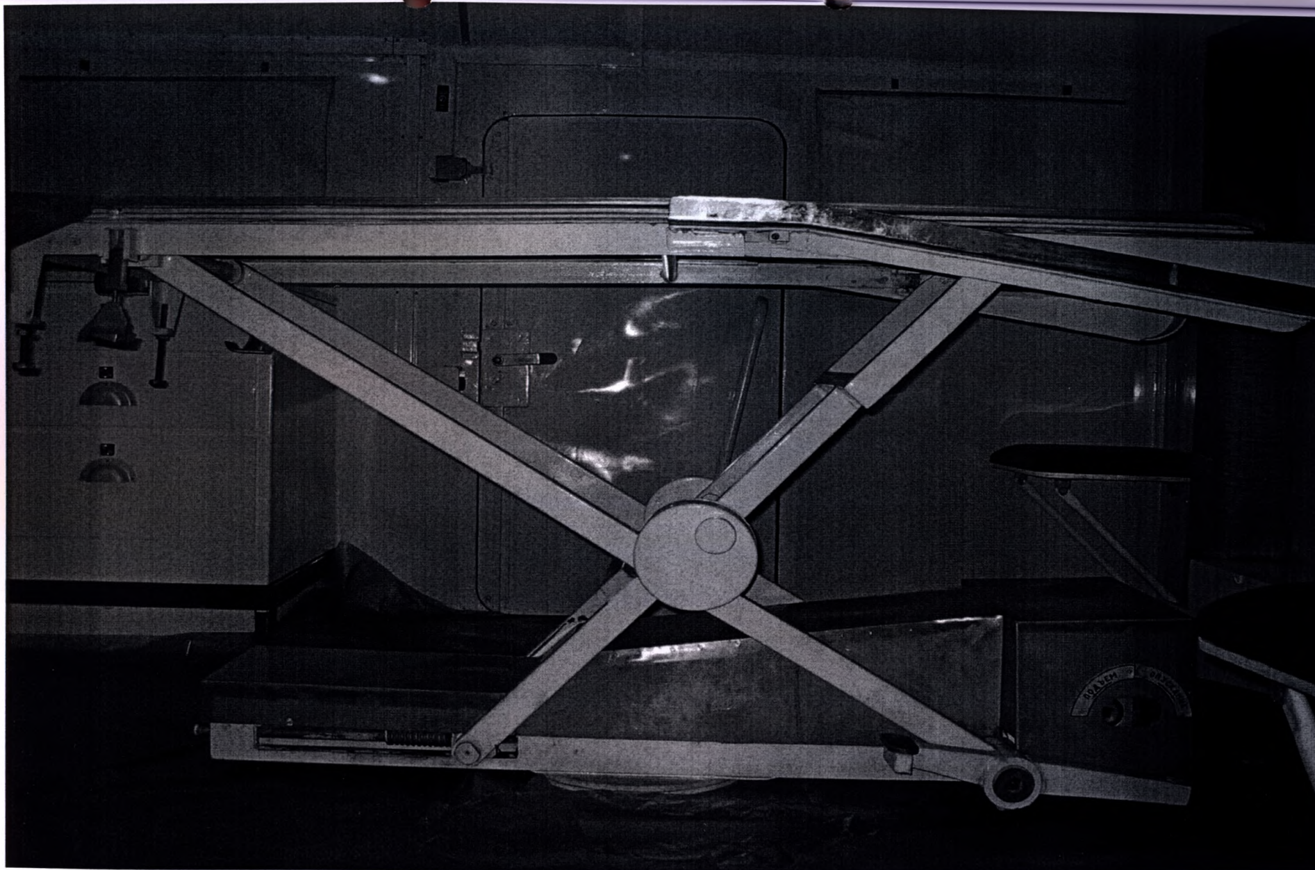
Фотография 6. Стол перевязочный механизированный для подвижных установок модернизированный ПМ-М внутри кузова-фургона. Общий вид.
