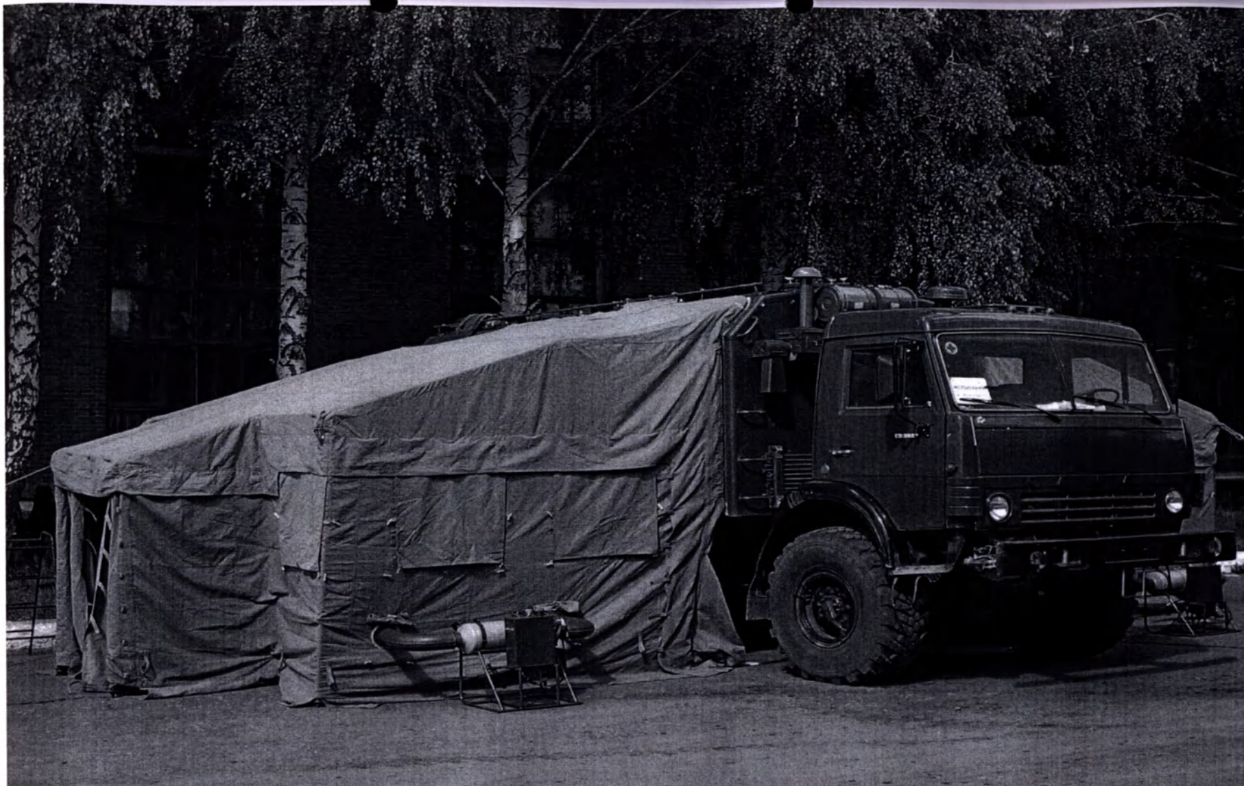
Фотография 2. Автоперевязочная АП-2-«СЗМО» в кузове-фургоне К4310 на шасси автомобиля КАМАЗ 43114 по ТУ 9451-004-07614018-2008. Вид сбоку.
