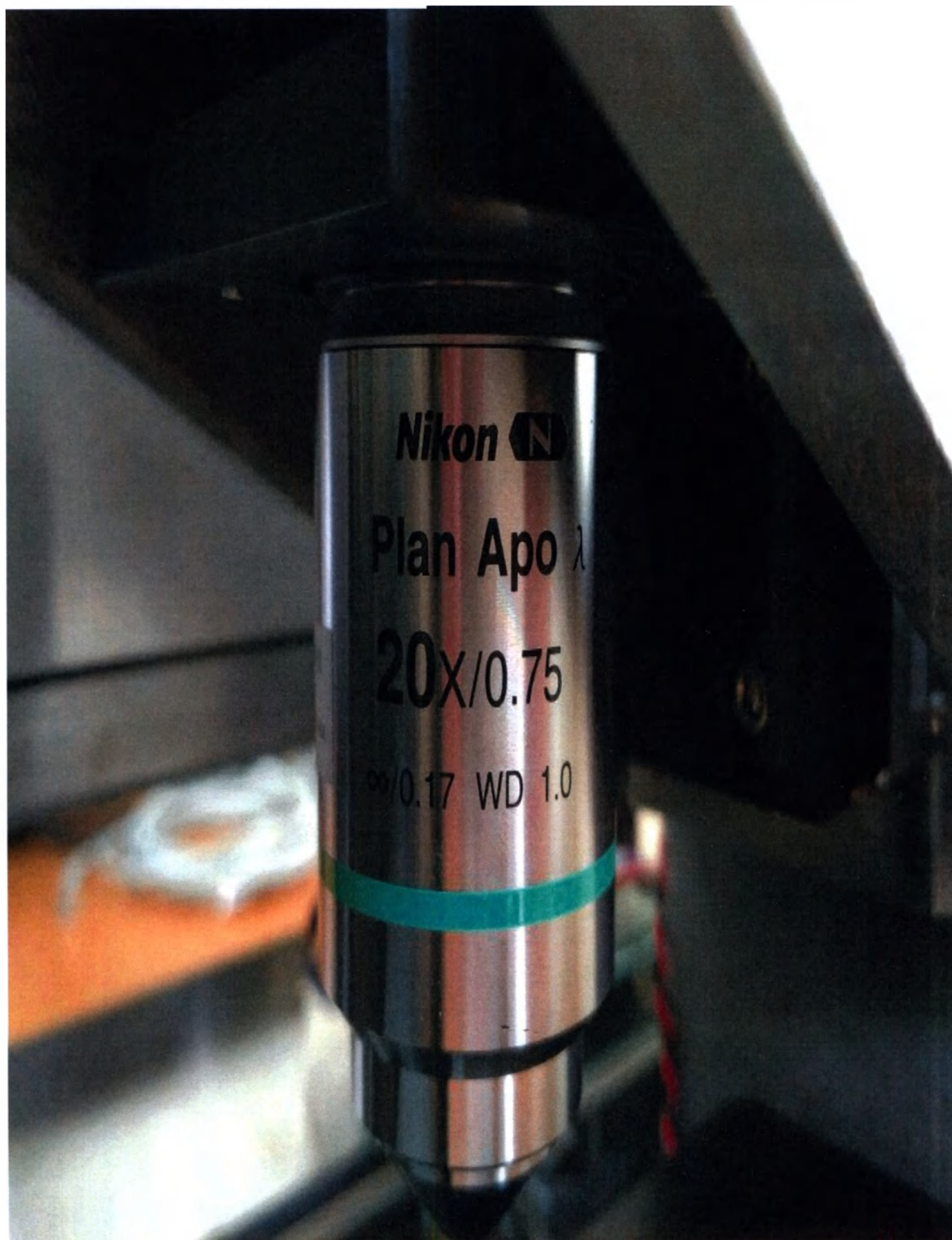
Рис.5. Объектив 20х/NA0.75: CFI Plan Apo Lambda 20х
