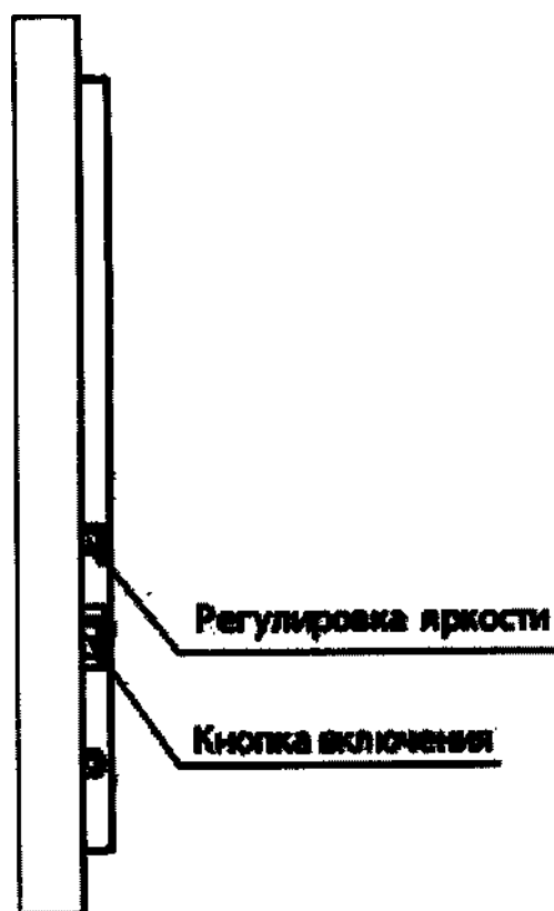
Рисунок 3 – кнопка включения негатоскопа и кнопка регулирования яркости негатоскопа
